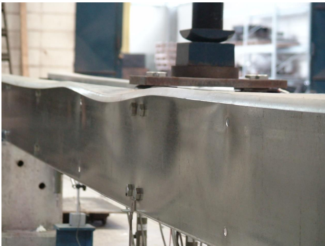
Foto 7 – Detalhe do modo de falha do protótipo Z1-C (modo distorcional).
