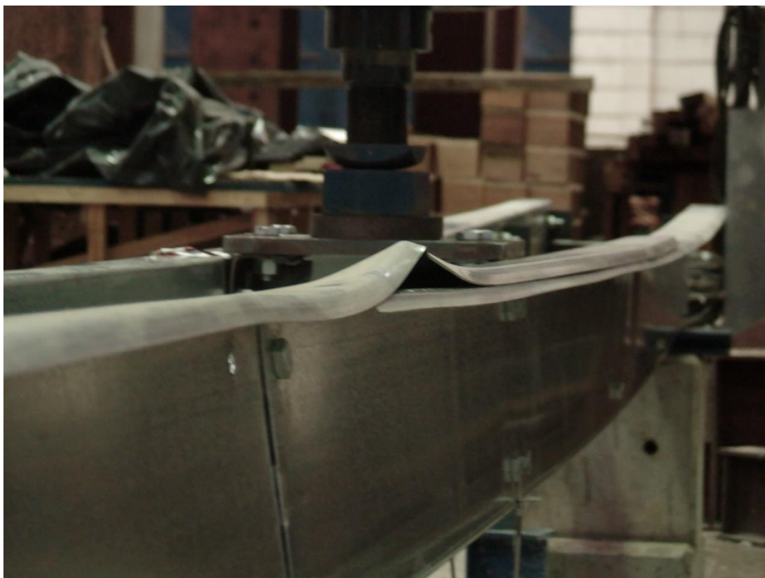
Foto 15 - Detalhe do modo de falha do protótipo Z2-T11 (modo distorcional).
