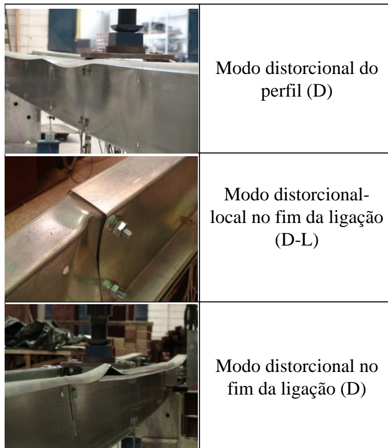
Figura 19 - Modos de falha observados nos ensaios.
