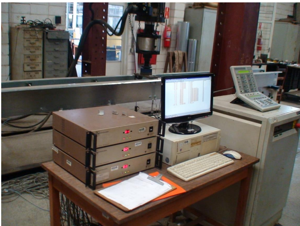
Foto 3 – Detalhe do sistema de aquisição dos dados.
