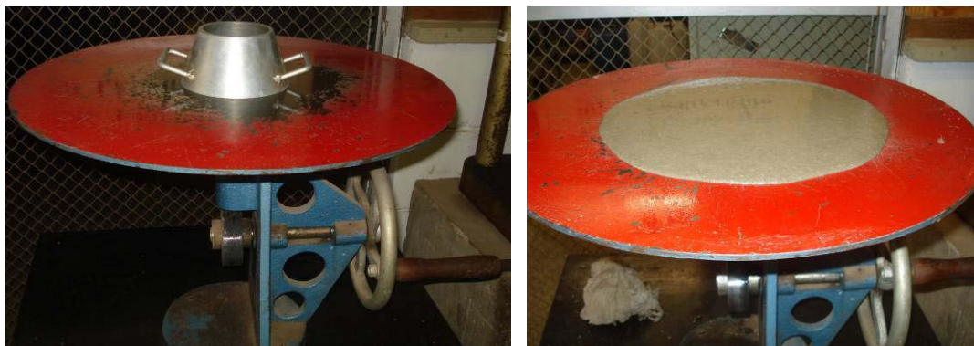
Figura 3.11 – Ensaio do índice de consistência na mesa de fluidez da argamassa
