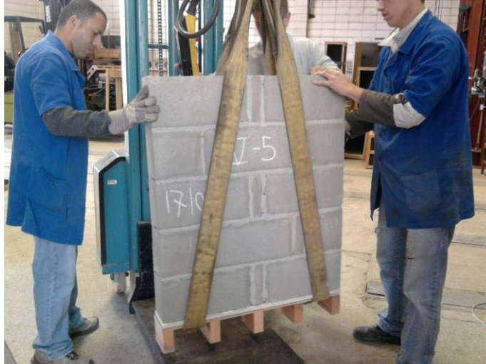
Figura 3.27 – Transporte das mini-paredes com o auxílio da ponte rolante e da empilhadeira elétrica
