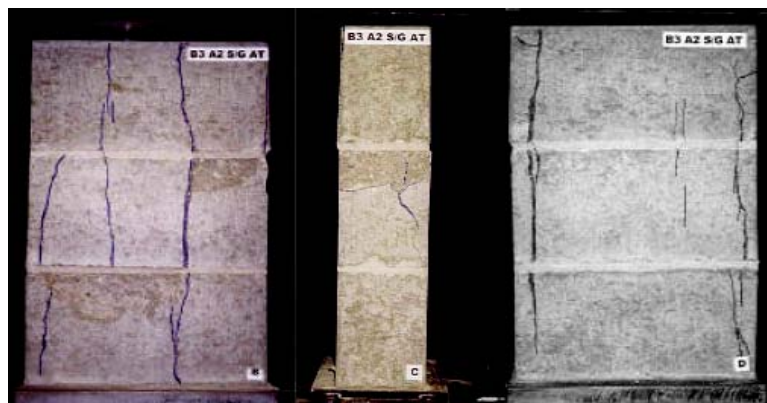
Figura 2.10 – Modo de ruptura dos prismas com argamassamento total (ROMAGNA, 2000)
