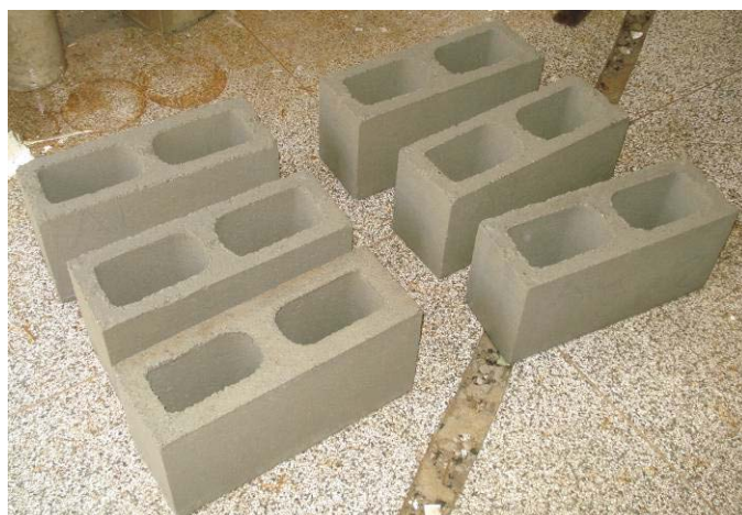
Figura 3.9 – Blocos colocados na câmara úmida para a obtenção da massa saturada ( m_2 )
