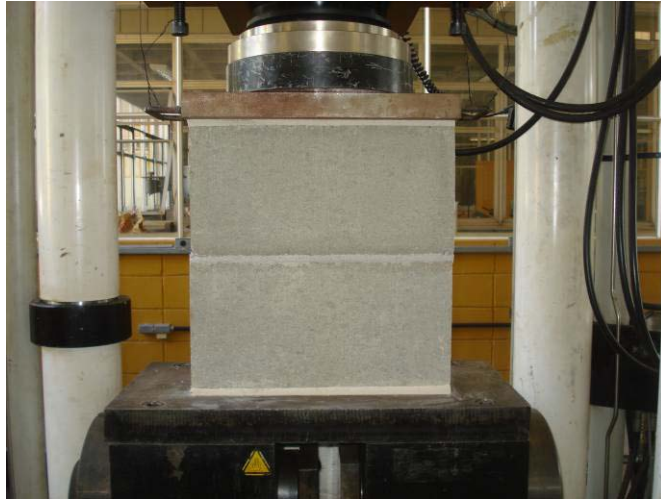
Figura 3.25 – Ensaio à compressão dos prismas na máquina servo-hidráulica universal marca INSTRON.
