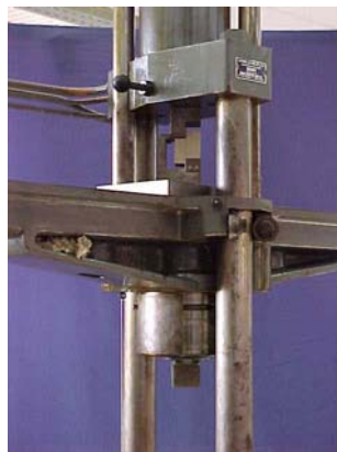
FIGURA 12 – Equipamento de ensaio - cisalhamento paralelo às fibras
