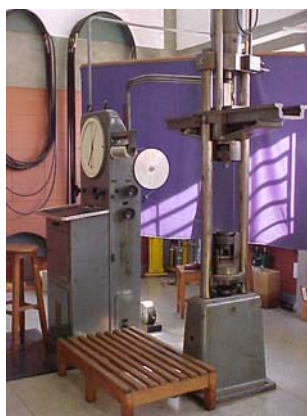
FIGURA 10 –Equipamento de ensaio - compressão paralela às fibras
