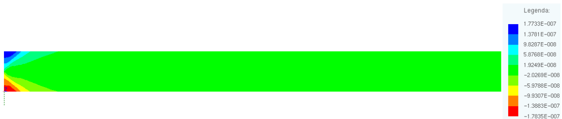
Figura 33 – Distribuição da deformação plástica equivalente na matriz elastoplástica perfeita
