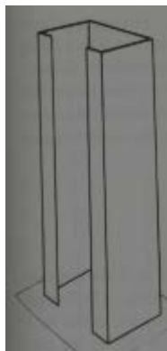
Figura 29. Núcleo estrutural tipo [Stafford, Smith 1991]
