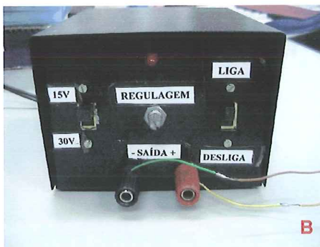
Figura 5. 11. Esquema elétrico(A) e montagem final (B) do circuito Transformador com tensão de saída ajustável.
