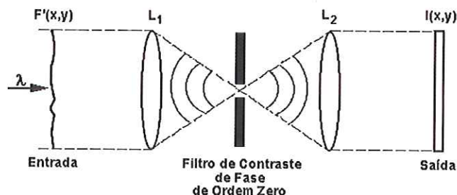
Figura 4.1 : Implementação da técnica de contraste de fase de ordem zero que utiliza um correlator óptico 4f .
