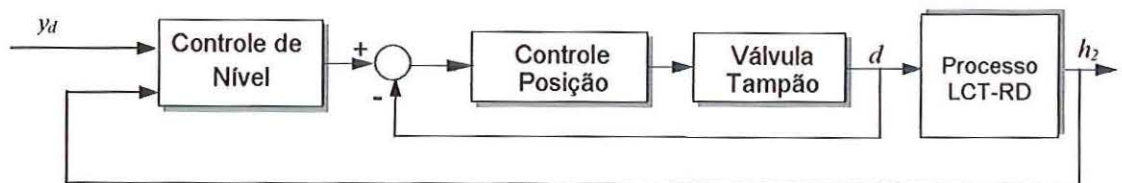
Figura 13 – Estrutura de controle do processo LCT-RD.
