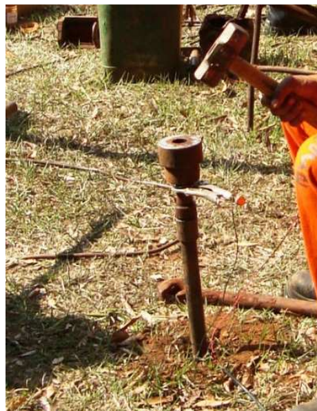
Figura 42: Ativação do trigger e geração de ondas no ensaio S-SPT
