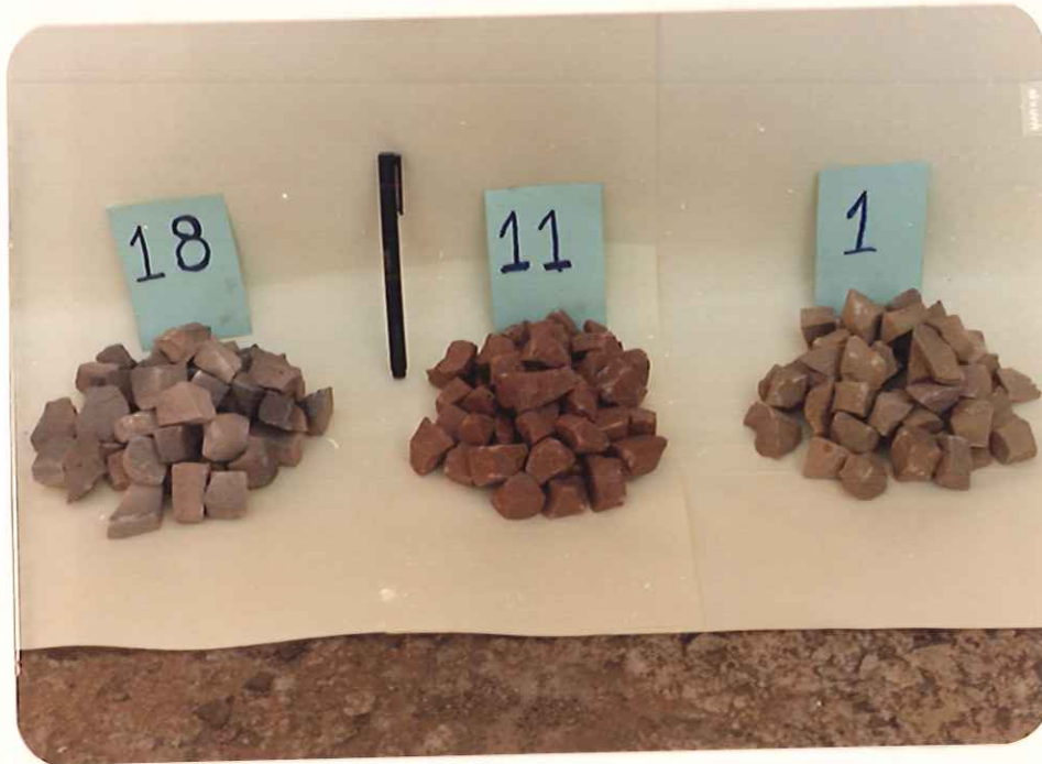
Figura 4.5: Amostras de arenito preparadas para ensaio de ciclagem água-estufa.
