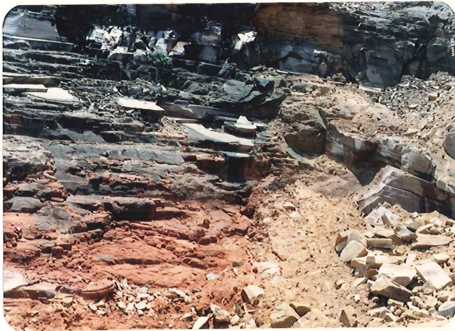
Figura 3.10: Extração de lajes na Pedreira Miglia- to. Note-se a falta de homogeneidade do material. Município de São Carlos.
