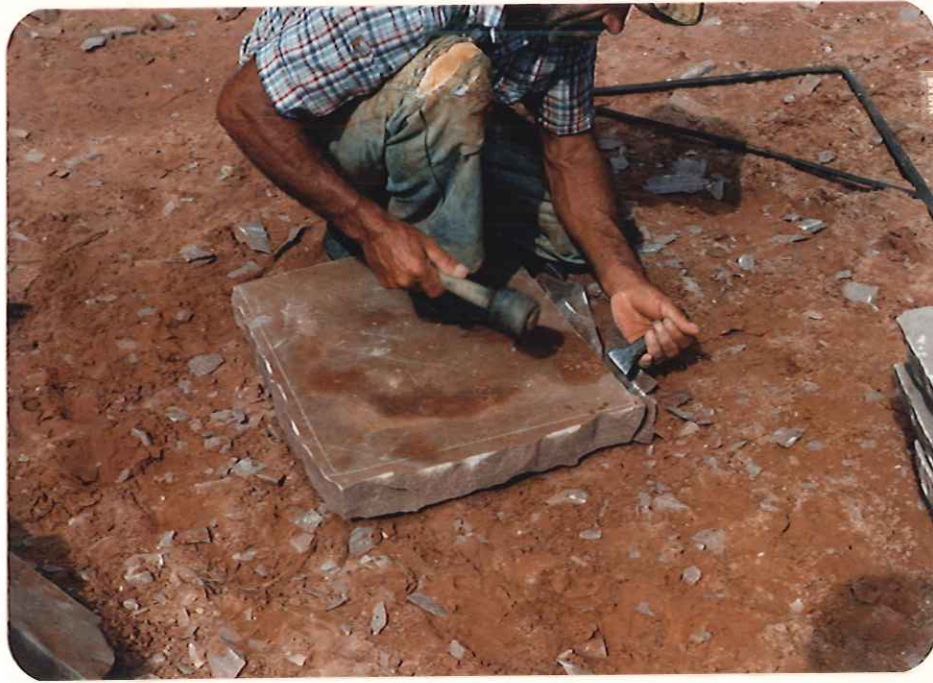
Figura 3.8: Aparelhamento manual de lajes. Pedreira Grosso. Município de Araraquara.
