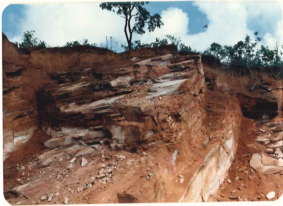
Figura 3.6: Extração de lajes em acamamento inclinado. Pedreira Grosso. Município de Araraquara.
