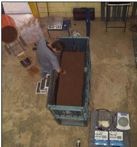
Figura 3.2. Visão geral da caixa de ensaios durante o período de construção do maciço.
