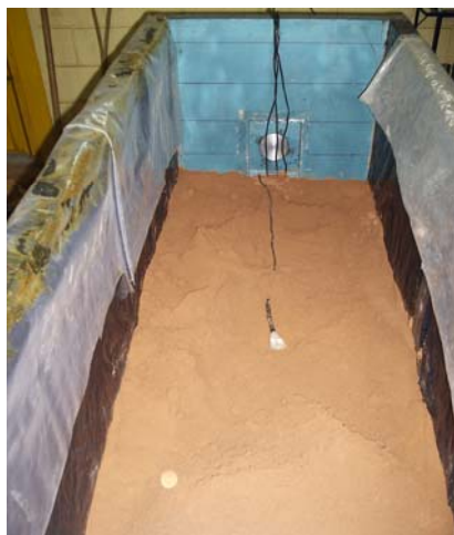
Figura 3.19. Posicionamento das células de tensão total tipo M (inclusão).
