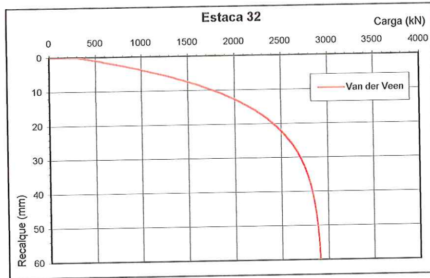
Figura 19. Prova de carga da Estaca 32 – Barueri/SP.
