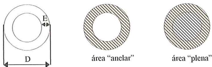
Figura 8.3.1. Geometria do elemento estrutural de fundação.
