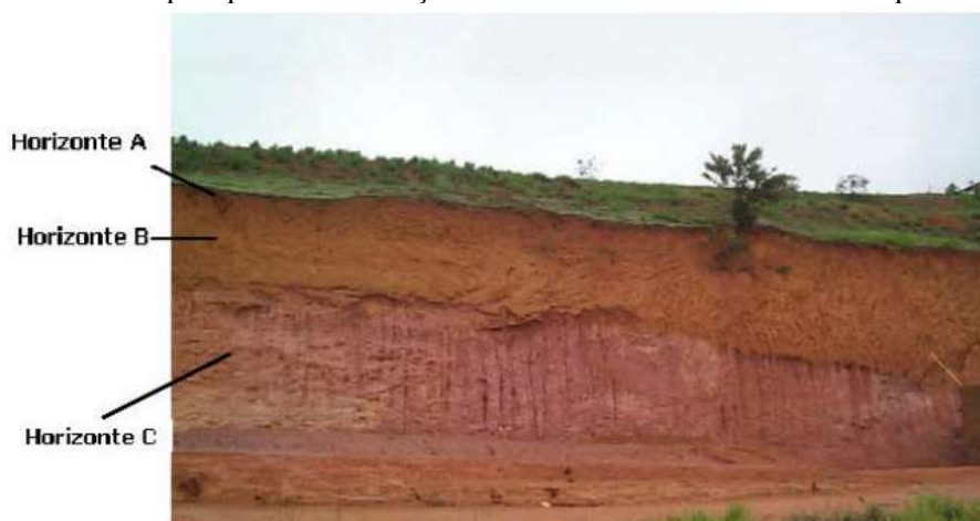
Figura 1 – Perfil de solo que apresenta distinção entre os horizontes laterítico e saprolítico.
