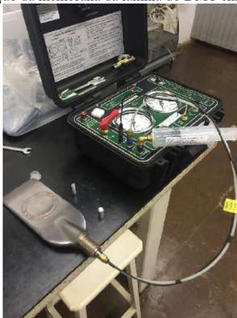
Figura 35 – Detalhe da calibração da membrana da lâmina do DMT em campo.
