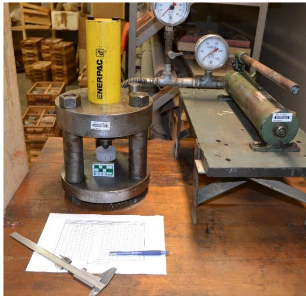
Figura 3.20 – Equipamento de ensaio de compressão puntiforme
