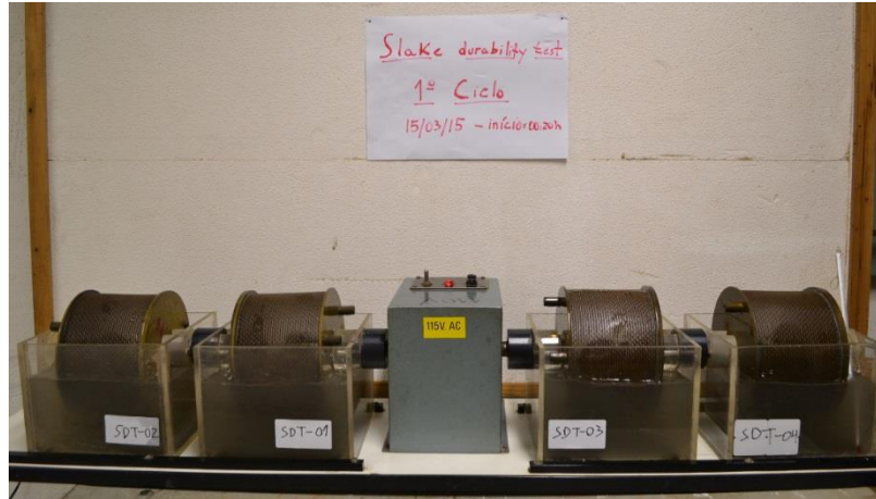
Figura 3.23 – Equipamento de desgaste em meio aquoso a partir de 4 tambores normalizados
