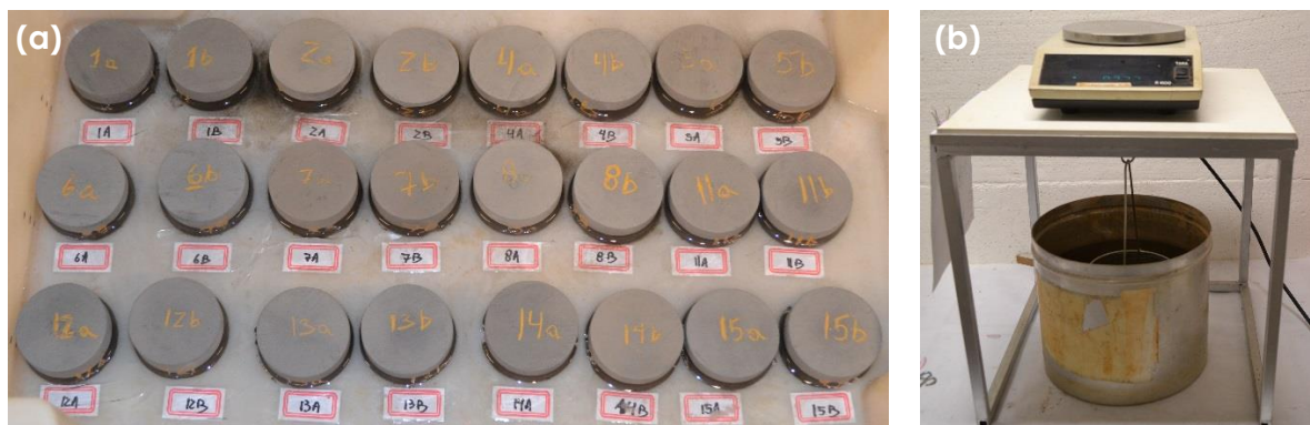
Figura 3.16 – (a) 1ª fase de umedecimento com água destilada até 1/3 da altura; (b) pesagem dos corpos de prova na condição submersa
