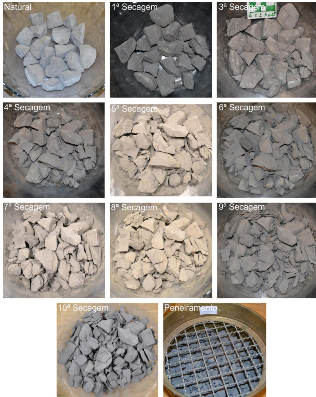
Figura 4.34 – Registro fotográfico do estado dos fragmentos de rocha após as etapas de secagem. Verifica-se o intenso fissuramento ao longo dos ciclos, evidente já com a primeira secagem. As imagens da 2ª secagem foram perdidas
