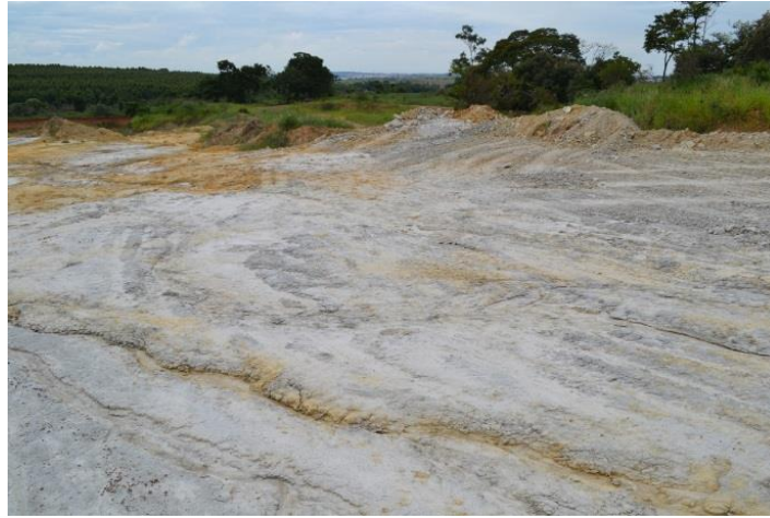
Figura 4.35 – Presença de particulado branco semelhante ao evidenciado nos ciclos de imersão e secagem
