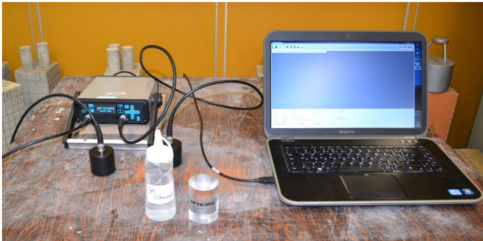
Figura 3.17 – Disposição do equipamento Proceq Pundit Lab: fonte registradora, par de transdutores, bastão de calibração, gel de acoplamento, cabo USP conectado ao laptop
