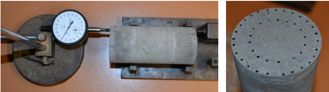
Figura 3.9 – Conferência da tolerância de paralelismo e rugosidade de topo e base
