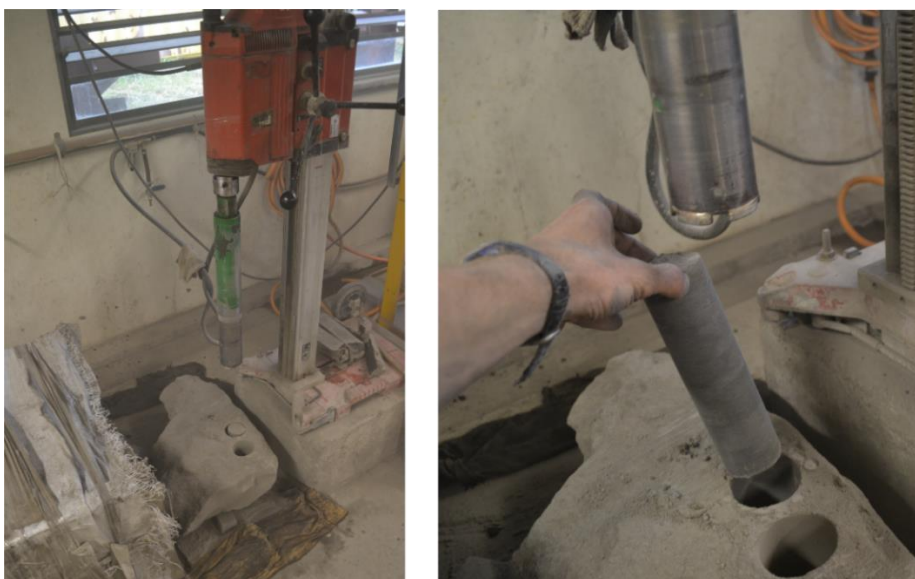
Figura 3.7 – Aspecto do bloco após a retirada da caixa de isolamento e retirada de testemunho
