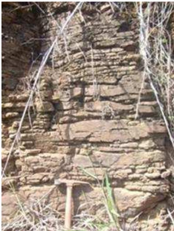
Figura 30 - Foto do ponto P25 com estrutura sedimentar com acamamento fino, existindo nesse ponto o contato entre as formações Botucatu e Serra Geral/Intrusivas Básicas.
