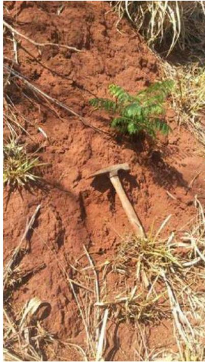
Figura 28 - Foto do ponto P8 da formação Serra Geral, composto por solos residuais de coloração vermelho escura e textura argilosa.
