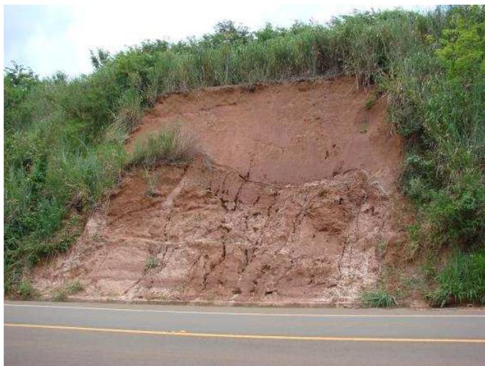
Figura 32 - Foto do ponto P27 correspondente à formação Botucatu, onde é possível verificar cicatriz de escorregamento em solo residual arenoso.
