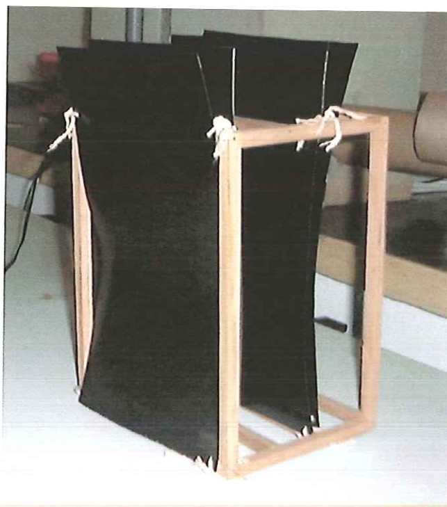
Figura 3.2. Grade de madeira, para fixação das geomembranas imersas em gasolina e óleo diesel, de forma que as amostras não estivessem em contato umas com as outras.
