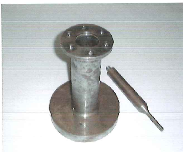
Figura 3.10. Equipamento utilizado no ensaio de punção, segundo a norma da ASTM D 4833.
