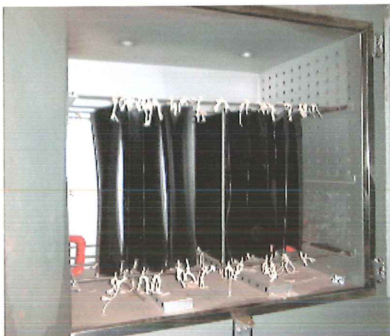
Figura 3.1. Amostras de PVC de 1,0 e 2,0 mm e de HDPE de 1,0 e 1,5 mm expostas à temperatura de 75^{\circ}\text{C} em estufa sem circulação de ar.
