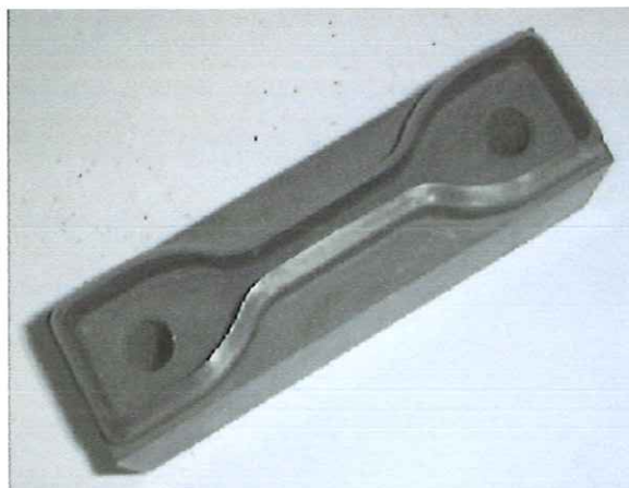
Figura 3.7. Molde biselado utilizado para obtenção dos corpos de prova para o ensaio de tração (Tipo IV).
