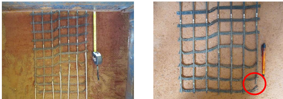
Figura 4.22. Exumação da geogrelha após o ensaio de arrancamento monotônico no equipamento de grandes dimensões – 50 kPa
