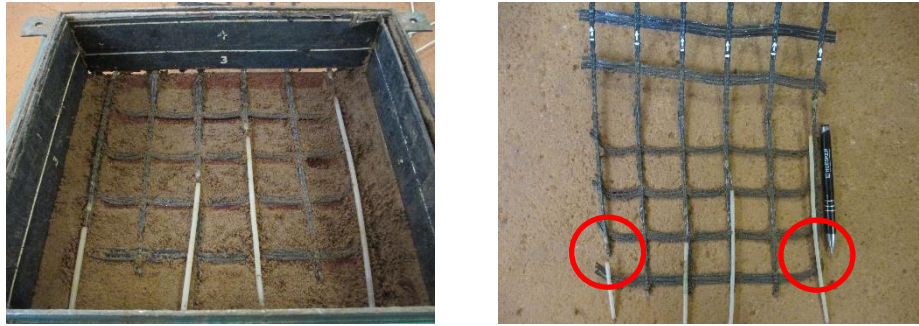
Figura 4.11. Exumação da geogrelha após o ensaio de arrancamento monotônico no equipamento de pequenas dimensões – 100 kPa
