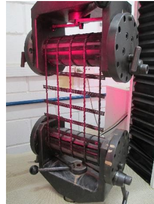
b. Caracterização da geogrelha no sentido longitudinal
