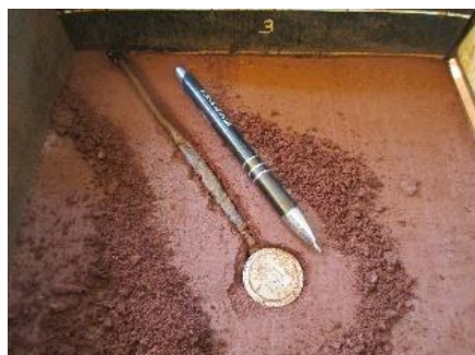
a. Escavação de 1 cm para a instalação da célula
