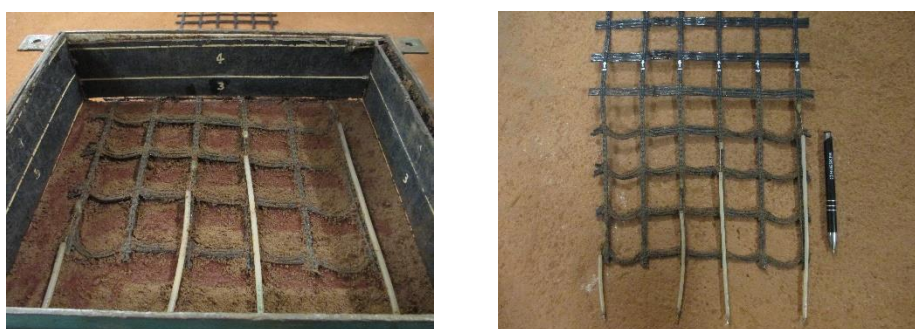
Figura 4.7. Exumação da geogrelha após o ensaio de arrancamento monotônico no equipamento de pequenas dimensões – 25 kPa
