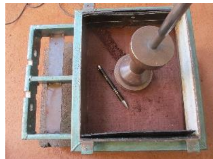
b. Compactação do solo
