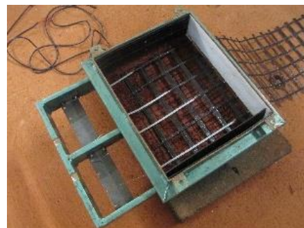
d. Escarificação da superfície de interface e instalação da geogrelha
