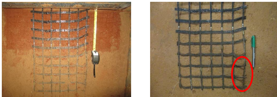
Figura 4.19. Exumação da geogrelha após o ensaio de arrancamento monotônico no equipamento de grandes dimensões – 25 kPa
