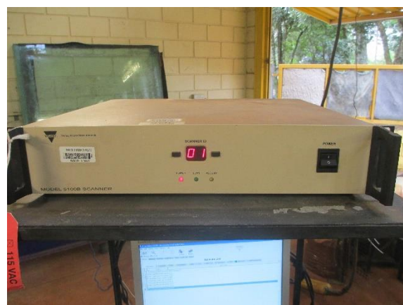
b. Detalhe do sistema de aquisição de dados SYSTEM 5000 (Modelo 5100B Scanner)
