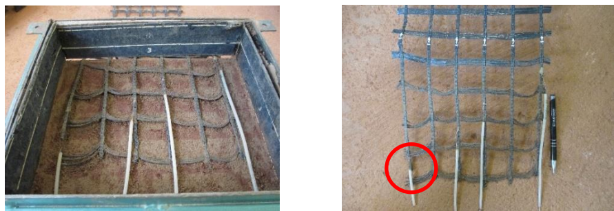
Figura 4.9. Exumação da geogrelha após o ensaio de arrancamento monotônico no equipamento de pequenas dimensões – 50 kPa
