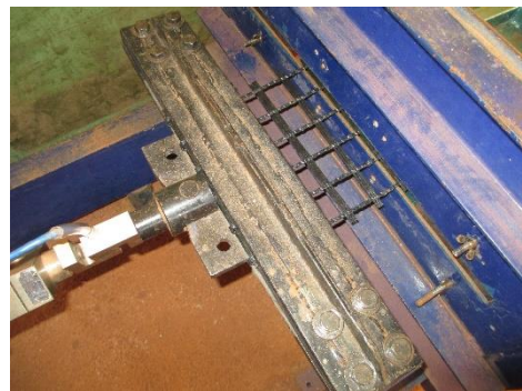
b. Garra de fixação instalada no sistema de aplicação de carga
