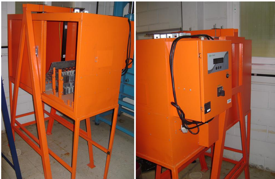
Figura 3-5 - Câmara térmica e controlador de temperatura
