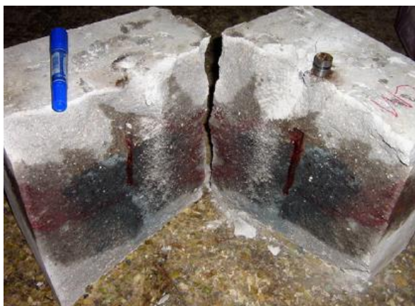
Figura 2.4 - Amostra ensaiada através do ensaio de fraturamento hidráulico.
