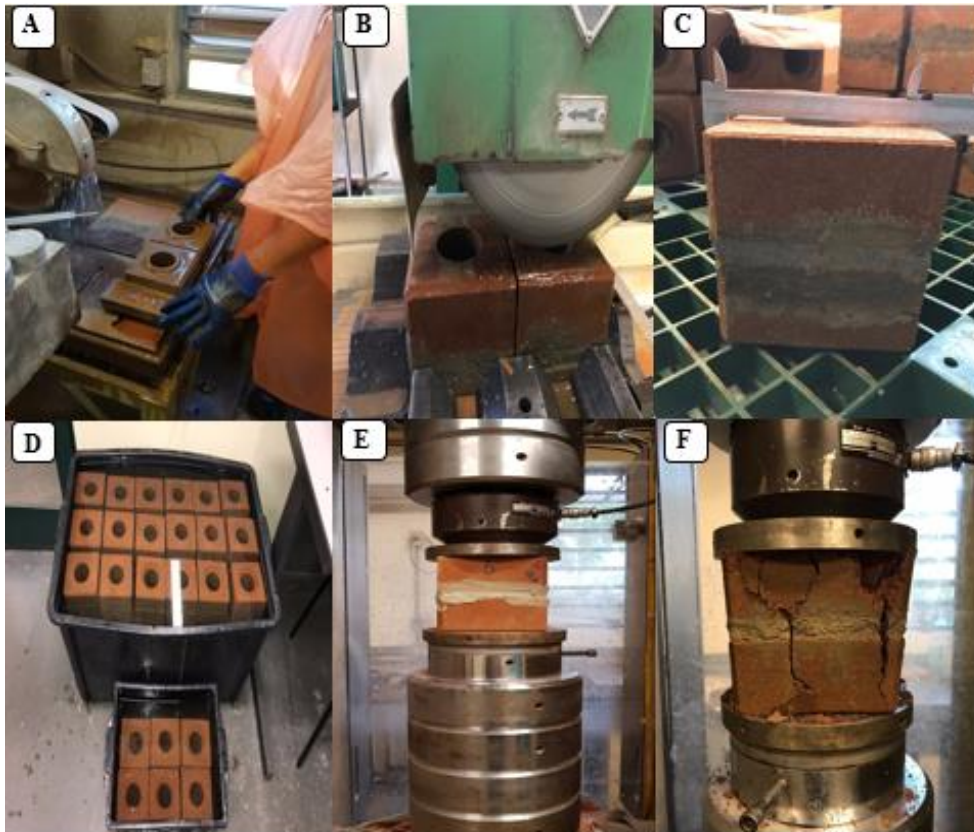
Figura 24 - Ensaio de resistência à compressão: (A, B e C) Corte, retifica e análise dimensional dos tijolos, (D) Imersão; (E) Corpo de prova sendo posicionado na prensa servo-controlada e (F) Aspecto de tijolo rompido após ensaiado.
