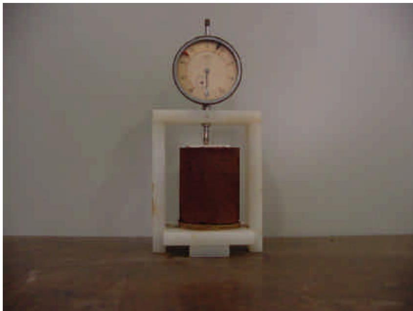
Figura 3.7 – Montagem do ensaio de contração axial. MACAMBIRA (2002).
