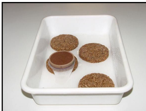
Figura 3.3 – Saturação dos corpos de prova para ensaios de curva de retenção de água.
