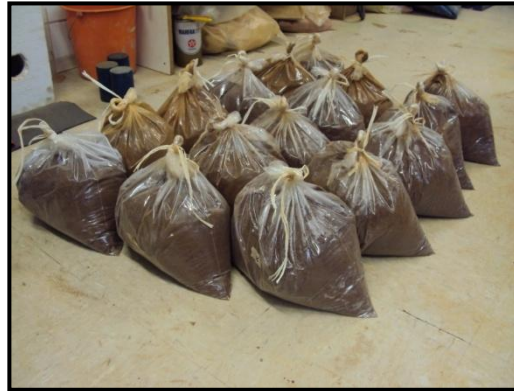
Figura 3.12 – Correção do teor de umidade em porções de 5 kg.
