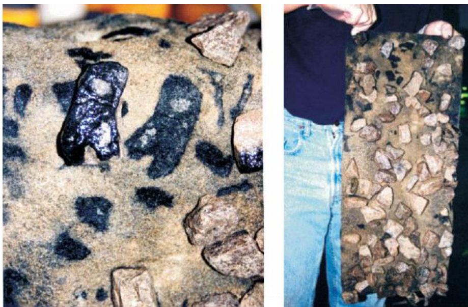
Figura 2.18 – Cimentação da camada drenante pelo lixiviado (McIsaac & Rowe, 2006)
