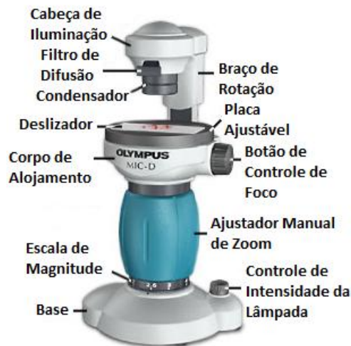
Figura 3.8 - Microscópio Digital Olympus MIC-D usado na pesquisa (Traduzido do site da empresa Olympus)
