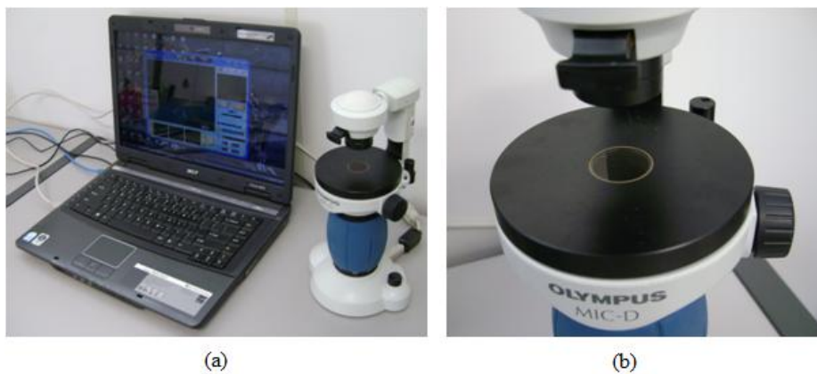
Figura 3.9– (a) Microscópio Digital ao lado do computador (b) detalhe da placa de vidro
