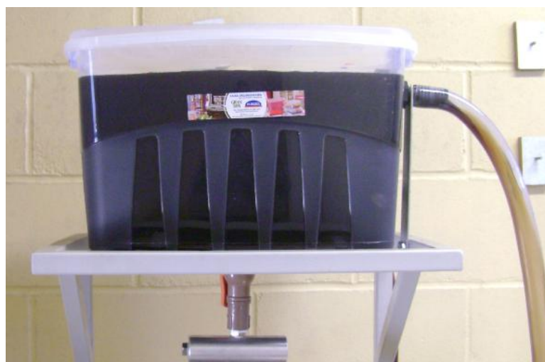
Figura 3.4 - Detalhe do extravasor instalado com a finalidade de manter a carga constante
