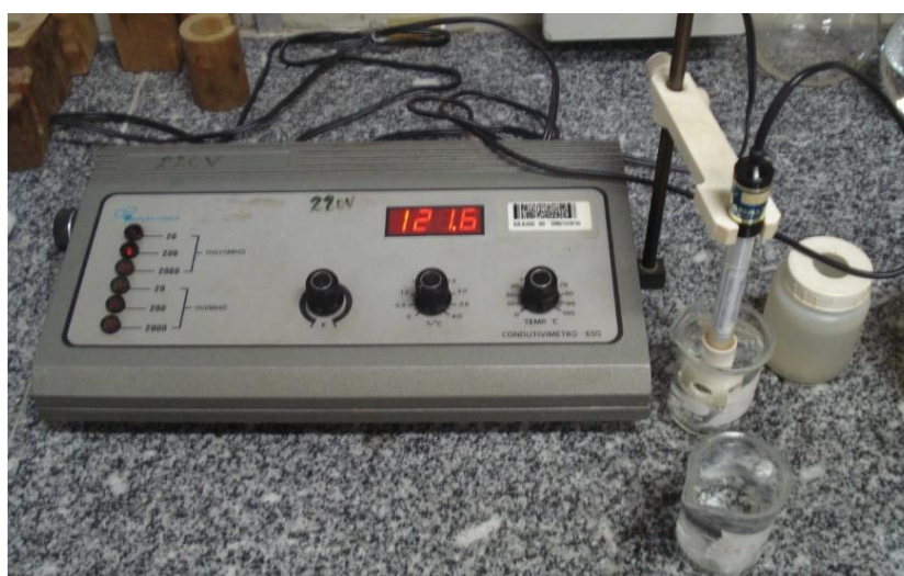
Figura 3.7 – Equipamento usado para medir eH e condutividade elétrica do lixiviado
