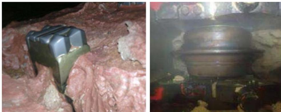
Figura 10 - À esquerda, scraper totalmente entupidos por efeito de clogging (adaptado de Comulada et al., 2016), à direita, disco de corte (diâmetro aproximado 17") sob efeito de clogging (adaptado de Shirlaw, 2015)
