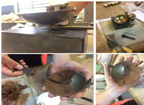
Figura 28 - Execução do Limite de Liquidez das amostras.
