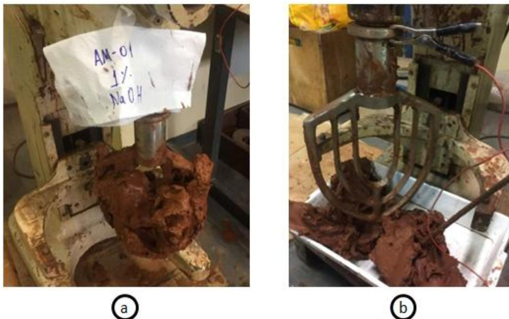
Figura 58 - AM 01 - comparativo de eficiência (a) antes da passagem da corrente elétrica, 1% NaOH (b) após aplicação de corrente contínua de 30V, 4A na condição 1% NaOH+CC.
