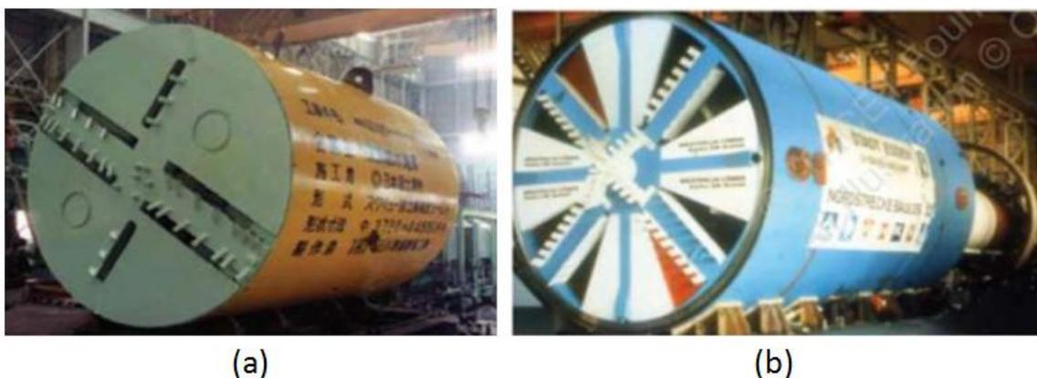
Figura 4 - (a) TBM - EPB lançado em 1974, Japão - (b) TBM. (EPB fabricado em 1986, Alemanha)
