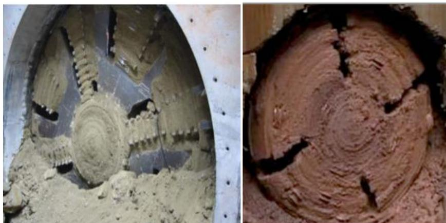
Figura 11 - (Esquerda) Efeito clogging em TBM (Martinotto, 2010), (Direita) Efeito clogging Solos Saturados (Langmaack, 2009).
