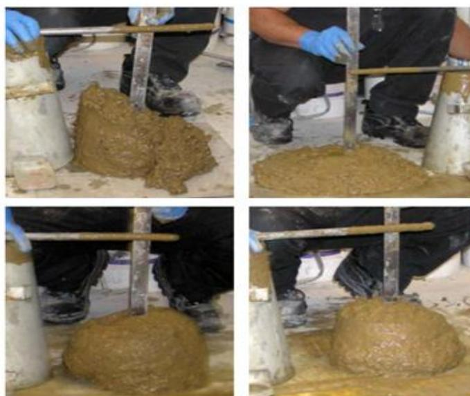
Figura 26 Estudo de condicionamento de solos para escavação EPB (Ball *et. al.*, 2009).
