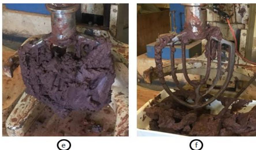
Figura 62 - AM 03 comparativo de eficiência (e) antes da passagem da corrente elétrica, 2% NaOH (f) após aplicação de corrente contínua de 30V, 4A na condição 2% NaOH +CC, umidade de 65%.
