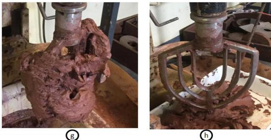
Figura 64 - AM 04 comparativo de eficiência (g) antes da passagem da corrente elétrica, 1% NaOH (h) após aplicação de corrente contínua de 30V, 4A na condição 1% NaOH +CC, umidade de 55%.
