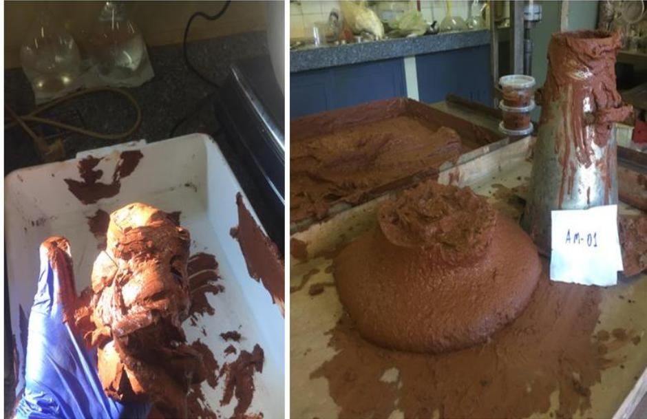
Figura 70 - Amostra AM-01 resultados de abatimento de cone com umidade de 85% e concentração de  $\text{NaOH}$  de 2%.
