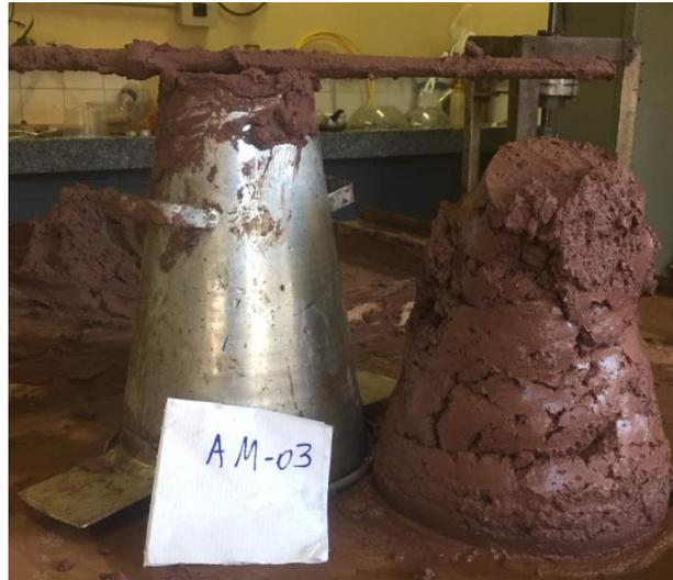
Figura 73 AM-03 abatimento de cone de 16,5cm umidade de 75% e concentração de 1% de *NaOH*.
