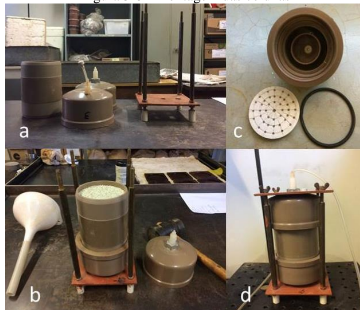
Figura 5-8 - Montagem das colunas
