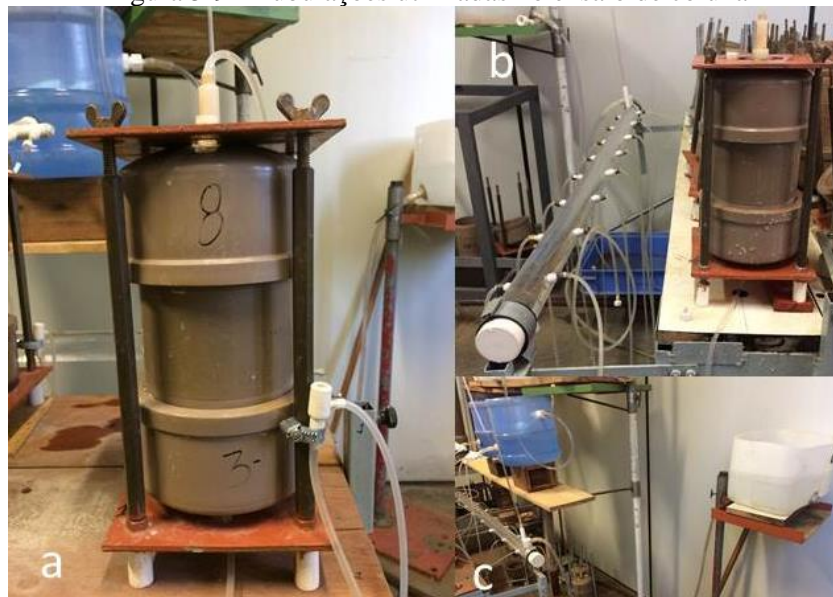
Figura 5-9 - Tubulações utilizadas no ensaio de coluna
