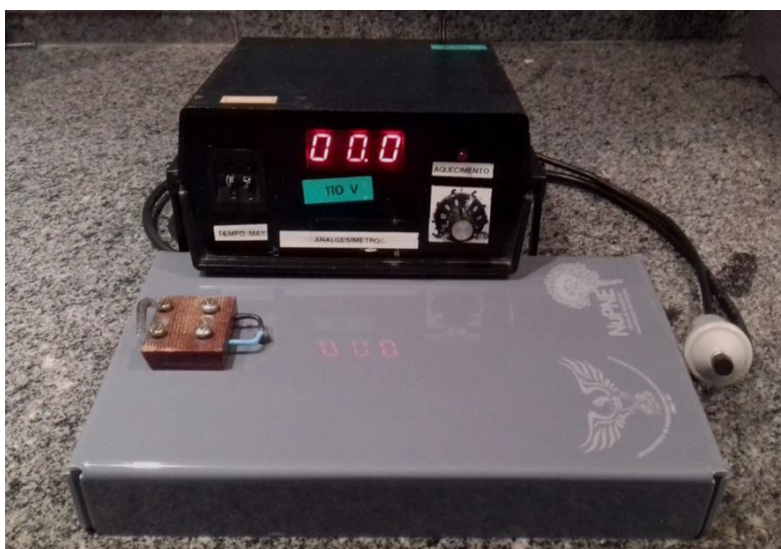
Figura 2: Analgesímetro usado para o teste de retirada de cauda.
