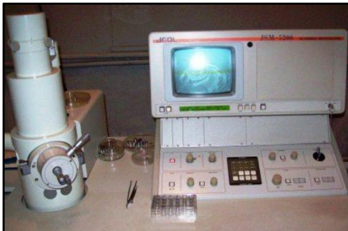
Figura 5 - Imagem do Microscópio Eletrônico JEOL SCANNING MICROSCOPE - JSM 5200
