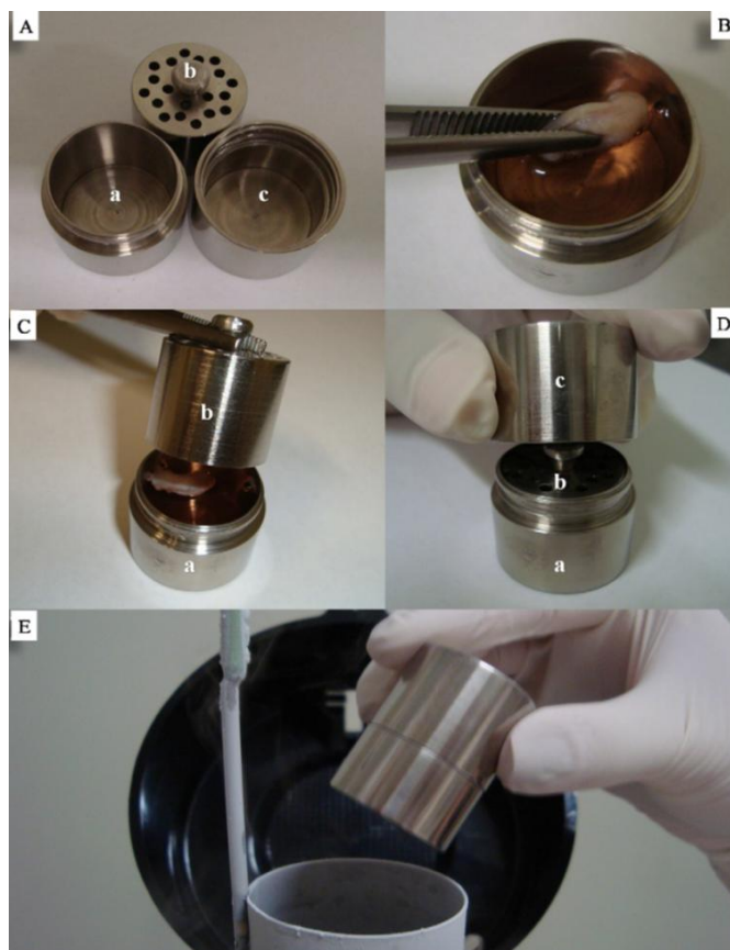
Figura 4: Ovarian Tissue Cryosystem : Novo dispositivo em aço inoxidável para procedimento de vitrificação de tecido ovariano caprino. (A) OTC aberto, permitindo a visualização das três partes constituintes: base (a), inserto (b) tampa (c). Notar as perfurações na parte superior do inserto para facilitar a colocação e remoção de soluções. (B) Exposição do ovário à solução de vitrificação na base do OTC. (C) A inclusão do inserto na base do OTC permite a manipulação asséptica do inserto. (D) Fechamento da base com a tampa do OTC. (E) Crioestocagem do OTC contendo a amostra (CARVALHO et al., 2013).
