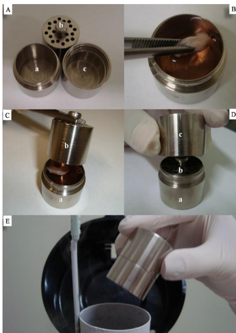
Figura 2: Ovarian Tissue Cryosystem : Novo dispositivo em aço inoxidável para procedimento de vitrificação de tecido ovariano caprino. (A) OTC aberto, permitindo a visualização das três partes constituintes: base (a), insert (b) tampa (c). Notar as perfurações na parte superior do insert para facilitar a colocação e remoção de soluções. (B) Exposição do ovário à solução de vitrificação na base do OTC. (C) A inclusão do insert na base do OTC permite a manipulação asséptica do insert. (D) Fechamento da base com a tampa do OTC. (E) Crioestocagem do OTC contendo a amostra (CARVALHO et al., 2013).
