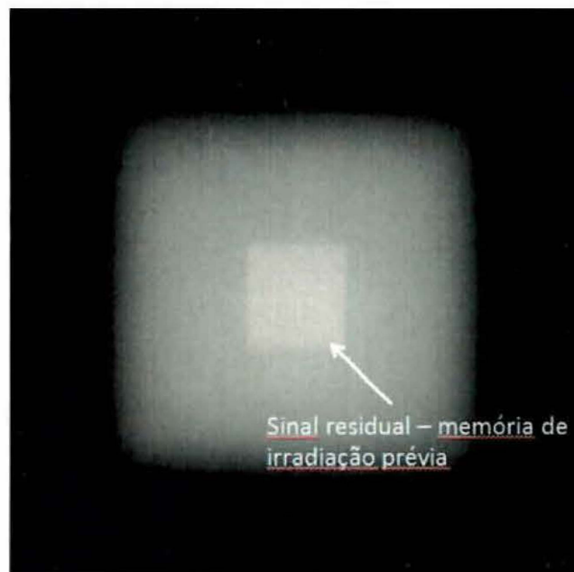
Figura 37: Efeito de persistência de imagem. A imagem residual do campo 5 \times 5 \text{ cm}^2 , irradiado com 100UM's, persiste na imagem do campo 20 \times 20 \text{ cm}^2 irradiado imediatamente após com 3MU's. O intervalo entre as irradiações foi apenas o necessário para o ajuste de tamanho de campo no ALC.
