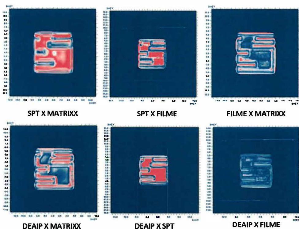
Figura 43: Representações iso- \gamma do OmniPro-I'mRT para cada um dos respectivos pares de distribuição de dose analisadas.
