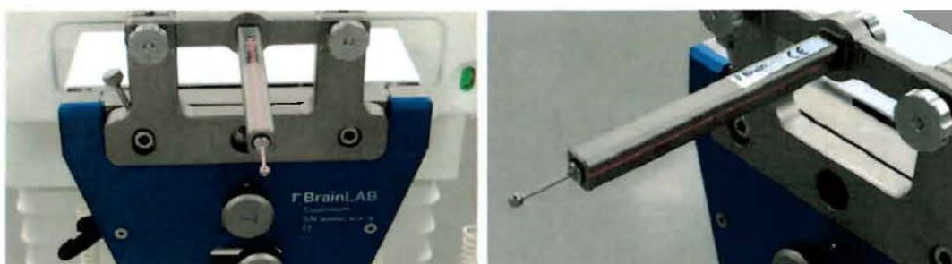
Figura 13: Dispositivo da Brain LAB para verificação do isocentro utilizado nas imagens do teste de centralização.
