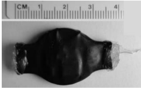
Figura 5 - Fotografia de um estimulador elétrico portátil implantável para estimulação crônica do SC de ratos.
