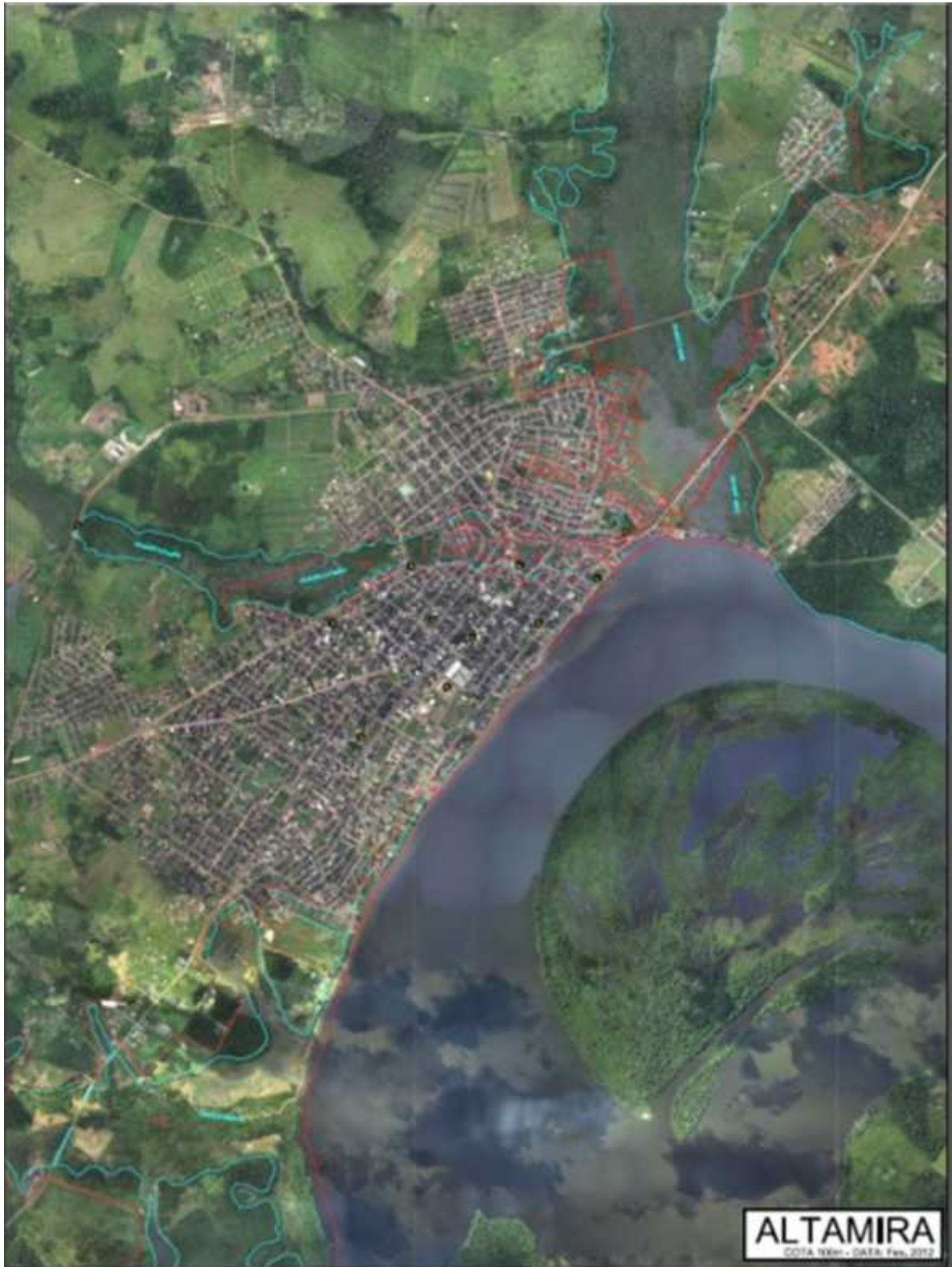
Figura 3.24 - Foto aérea com delimitação da cota 100 e dos setores, registro usado para a remoção da população que habita o Igarapé Altamira. Fonte: Fornecida pelo CNEC Worley Parsons. O Igarapé Altamira se encontra na parte superior da foto, entre as duas manchas urbanas, delimitado por uma linha esverdeada.
