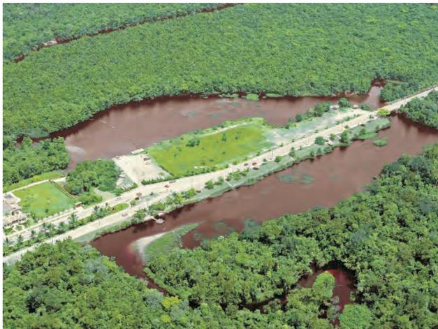
(7) A modificação de cursos d'água provocado pelos aterros na construção de ruas provoca alterações na velocidade da água, acentuando processos de erosão e assoreamento. Foto Roberto Sakamoto, 2007.
