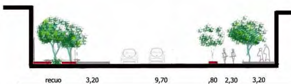
Figura 54. Ciclofaixa na rua Curuçá. A largura da via e as dificuldades de intersecções propõe a situação de faixa dupla.
