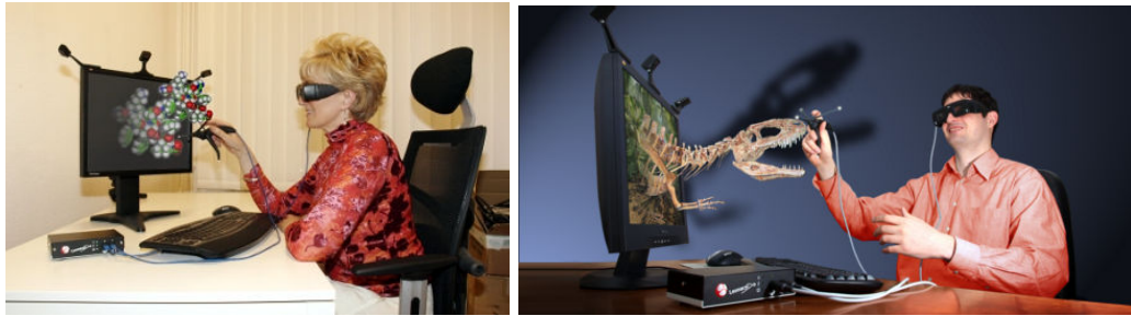
Figura 12: Exemplos de aplicação de realidade aumentada com Vídeode Construção 3D com o software Leonar3Do, interfaces táteis do tipo haptic e óculos 3D, todos disponíveis comercialmente. Fonte: disponível em http://leonar3do.com/?q=en/node/70 - acessado em 19/02/2010
