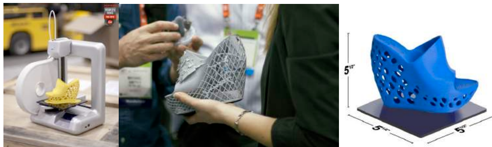
Figura 71 - Impressora 3D Cubify com área de impressão de um cubo com 5 1/2 polegadas de aresta. Fonte: Cubify 3D (2012).
