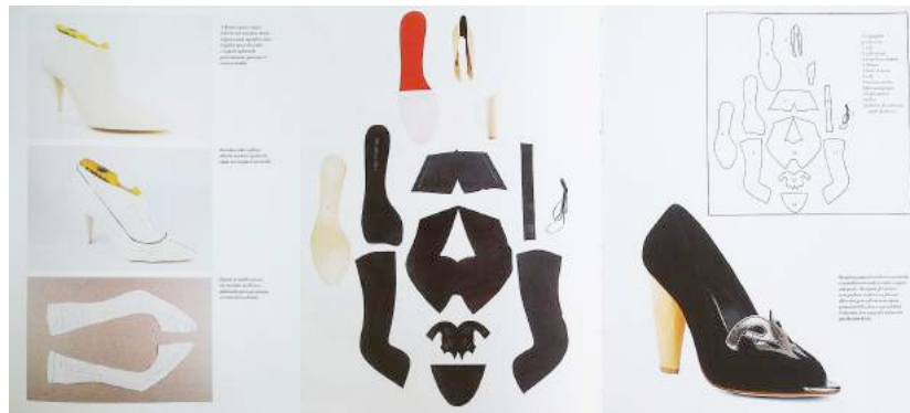
Figura 45 - Modelagem com uso de fita-crepe sobre a fôrma e planificação das partes de um calçado. Fonte: Choklat (2012).
