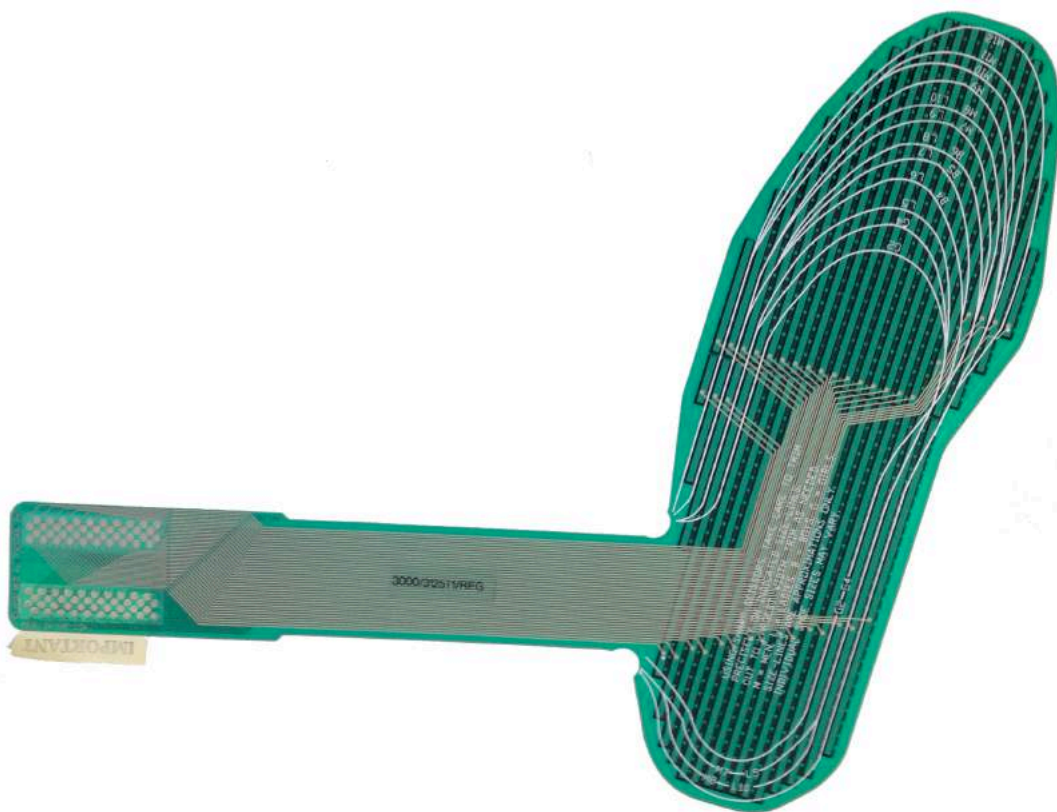
Figura 112 - Modelo de palmilha com sensores utilizada no teste de baropodometria. Fonte: Acervo pessoal.
