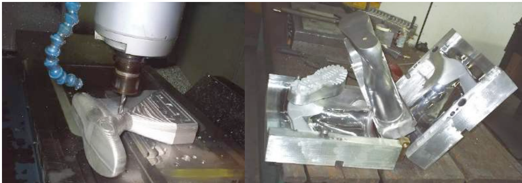
Figura 49 - Complexa matriz para injeção de botas de borracha (galochas), usinadas em torno CNC. Fonte: Acervo pessoal.
