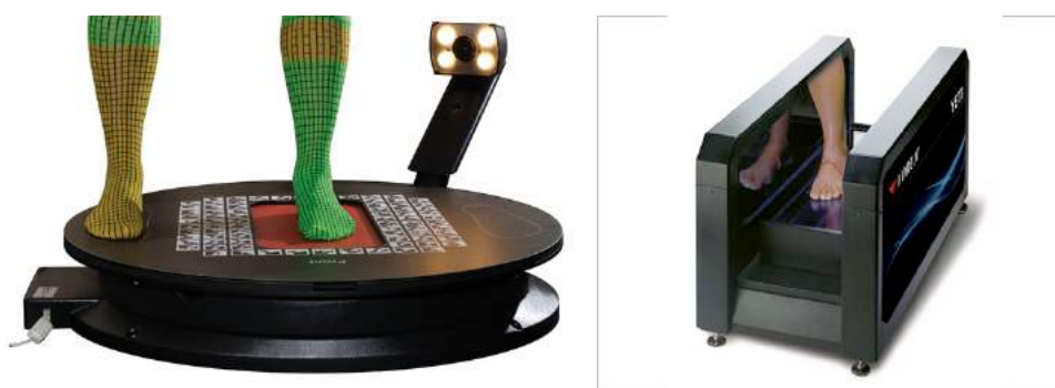
Figura 55 - Equipamentos de captura digital de informações pertinentes a projeto de calçados, adaptados com sensores piezoelétricos na palmilha para determinação da pressão plantar e scanner de pés. Fonte: da esquerda para a direita, LeftShoeCompany, USA e Vroom, Canadá (2015).
