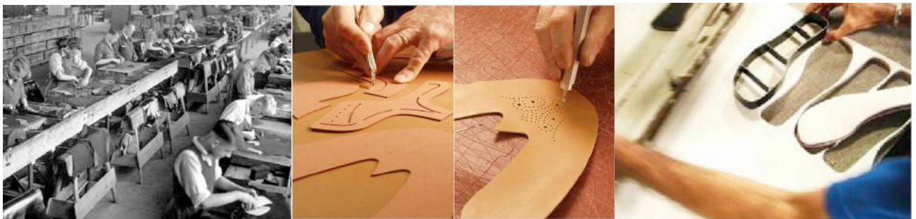
Figura 50 - À esquerda, posto de trabalho de corte industrial da década de 60; ao centro, corte artesanal na Itália, em 2010, ambos com uso de navalha para corte. Na imagem da direita tem-se o uso de faca de corte e balancim para corte de palmilhas. Fonte: Choklat (2012).
