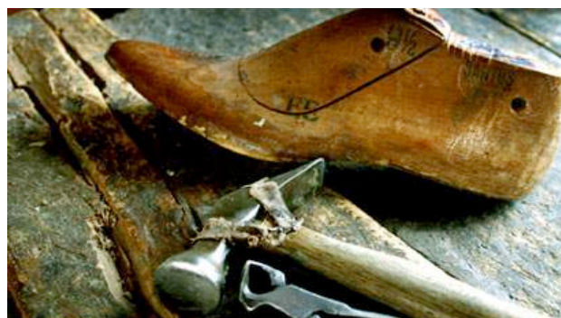
Figura 47 - Fôrma de madeira ainda utilizada por sapateiros. Fonte: www.novohamburgo.org (2016).
