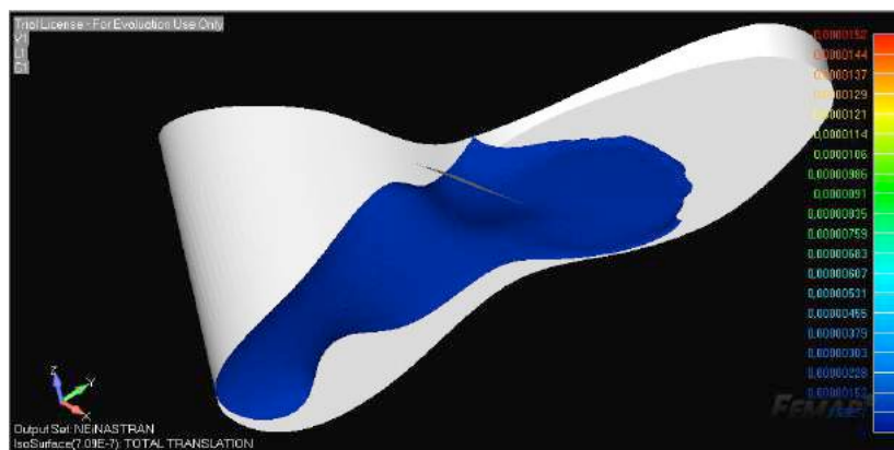
Figura 128 - Superfície gerada no ensaio de Total Translation no calçado com salto 9cm, em uma determinada faixa de tensão. Fonte: Acervo pessoal.
