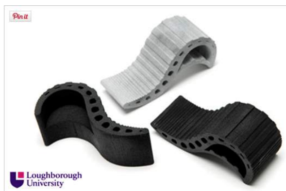
Figura 105 - Amostras de materiais fabricados com impressão 3D testando desenhos estruturais diversos para verificação da resistência da peça. Fonte: www.lboro.ac.uk/microsites/enterprise/e2hs/technology/HSS/case-studies/robust-parts.html .
