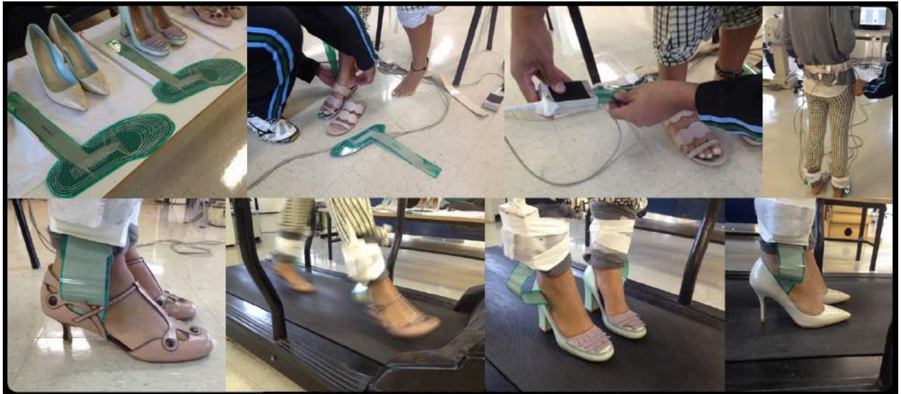
Figura 113 - Ensaio de baropodometria para obtenção da distribuição das pressões plantares em calçados femininos, realizados no Laboratório de Estudos dos Movimentos do Hospital das Clínicas de São Paulo. Fonte: Acervo pessoal.
