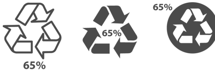
Figura 14 – Exemplos de posições do valor percentual quando se utiliza o Ciclo de Möbius para fazer declarações sobre conteúdo mínimo de material reciclado na composição. Fonte: ISO 14021, 1999
