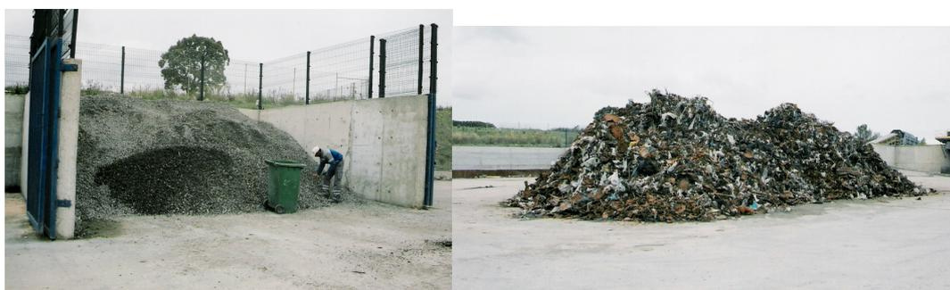
Figuras 6.11 e 6.12 – Materiais ferrosos e não ferrosos retirados das escórias – ITVE – aterro sanitário Mato da Cruz – Vila Franca de Xira – Portugal
