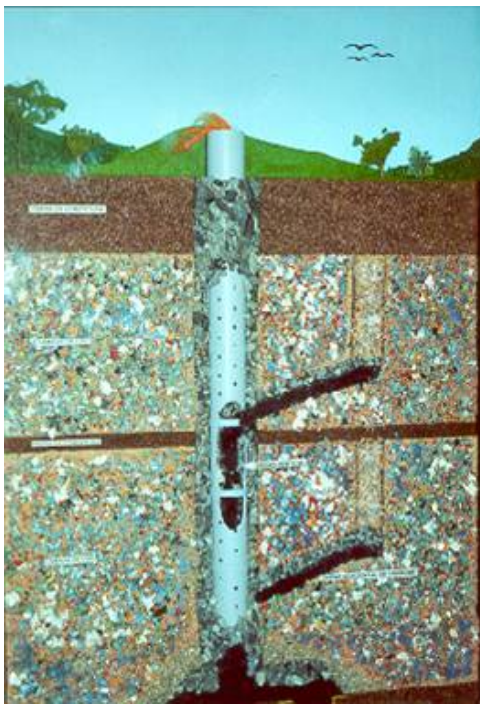
Figura 4.4 – Corte esquemático do aterro São João com sistema de drenagem de gases e líquidos – São Paulo – 2002 Foto: Geraldo Gomes Serra.
