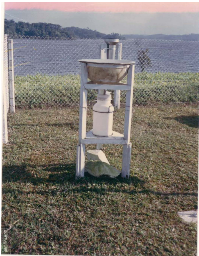
Figura 6. Coletor de precipitação. Estação de amostragem Serra do Mar, localizada no pos- to pluviométrico Barragem de Pedras (ELETROPAULO S/A).
