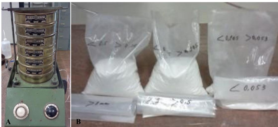
Figura 11 - A) Agitador mecânico; B) Areia separada em faixas de diâmetro de partículas
