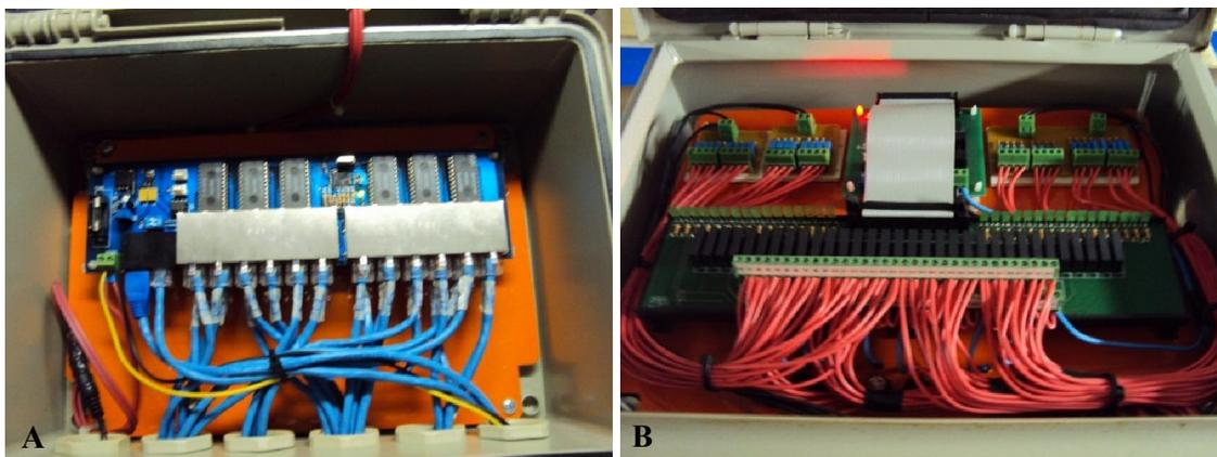
Figura 9 - A) Módulo microprocessado para aquisição de dados; B) Módulo microprocessado para controle de válvulas
