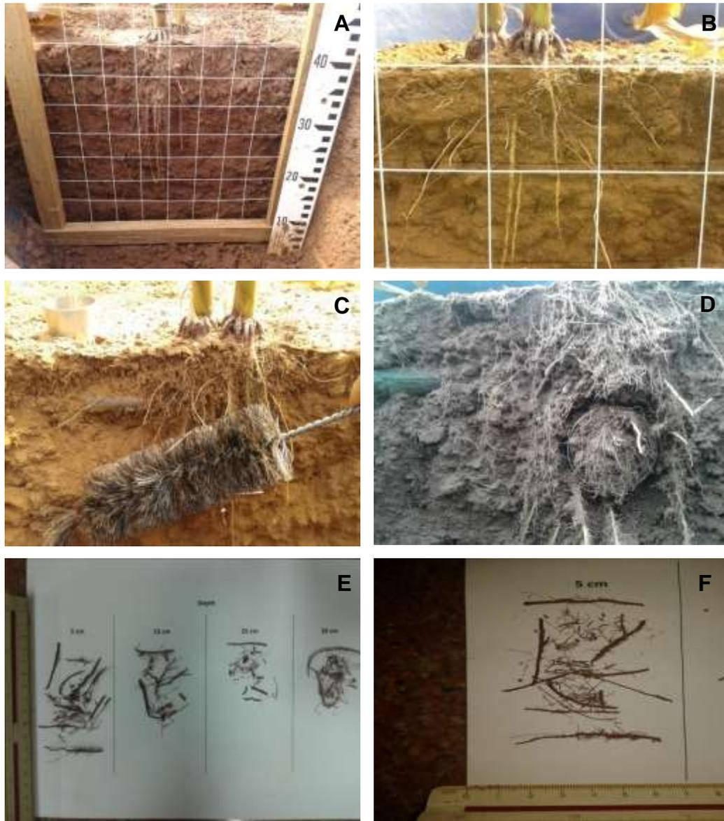
Figura 19 - (A) Abertura do perfil do solo em lisímetro de drenagem, (B) Limpeza do perfil do solo para exposição do sistema radicular, (C) Amostragem indeformada da densidade radicular ao longo do perfil do solo, (D) (E) e (F) diferenciação do comprimento radicular amostrado em cada profundidade do solo
