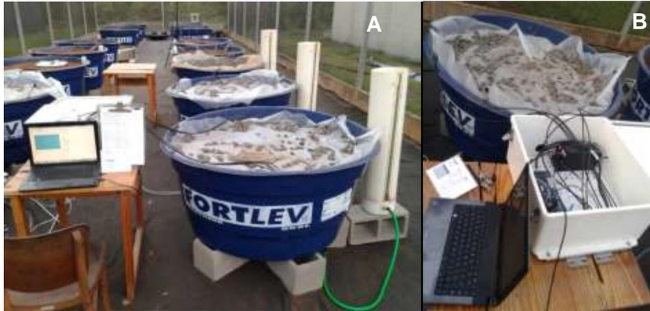
Figura 8 - Monitoramento inicial da umidade volumétrica do solo para modelagem inversa dos parâmetros físico-hídricos do solo (A), e monitoramento da redistribuição da água no solo (B)
