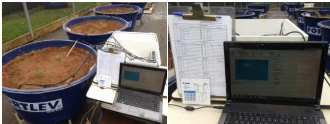
Figura 12 - Monitoramento da umidade volumétrica do solo e da condutividade elétrica da solução do solo em lisímetro de drenagem sob cultivo do milho, após 5 dias de plantio
