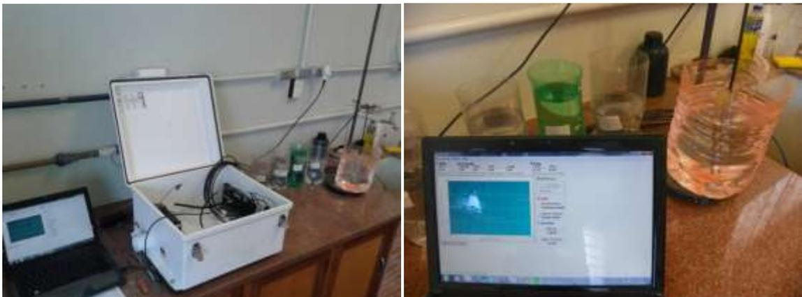
Figura 11 - Procedimentos experimentais para determinação do  $K_p$  de sondas TDR
