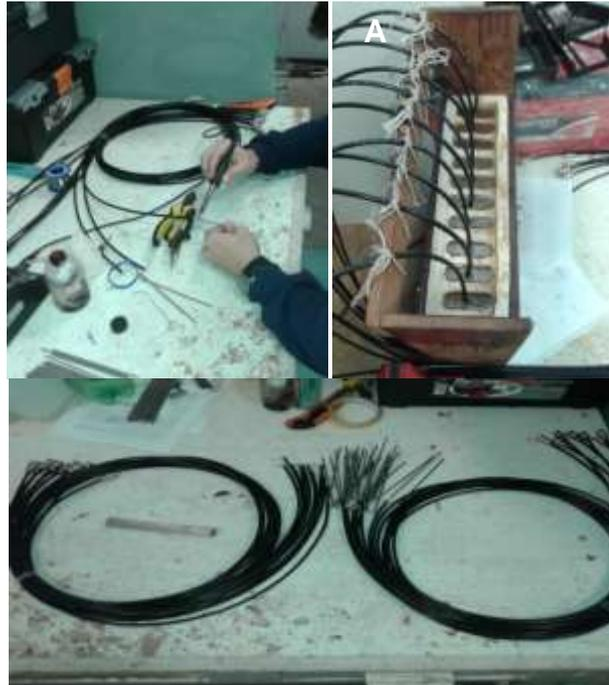
Figura 10 - (A) Instalação dos conectores e solda da extremidade oposta do cabo coaxial; (B) gabarito de madeira empregado no auxílio da secagem do composto (resina e catalisador) responsável pela estruturação das hastes em 10 sondas TDR e (C) conjunto de cabos com conectores prontos para serem soldadas hastes de inox
