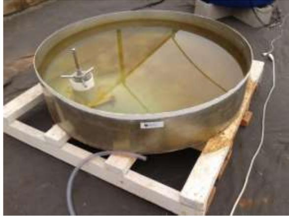
Figura 20 - Tanque Classe "A" empregado para estimar evaporação do solo em ambiente protegido
