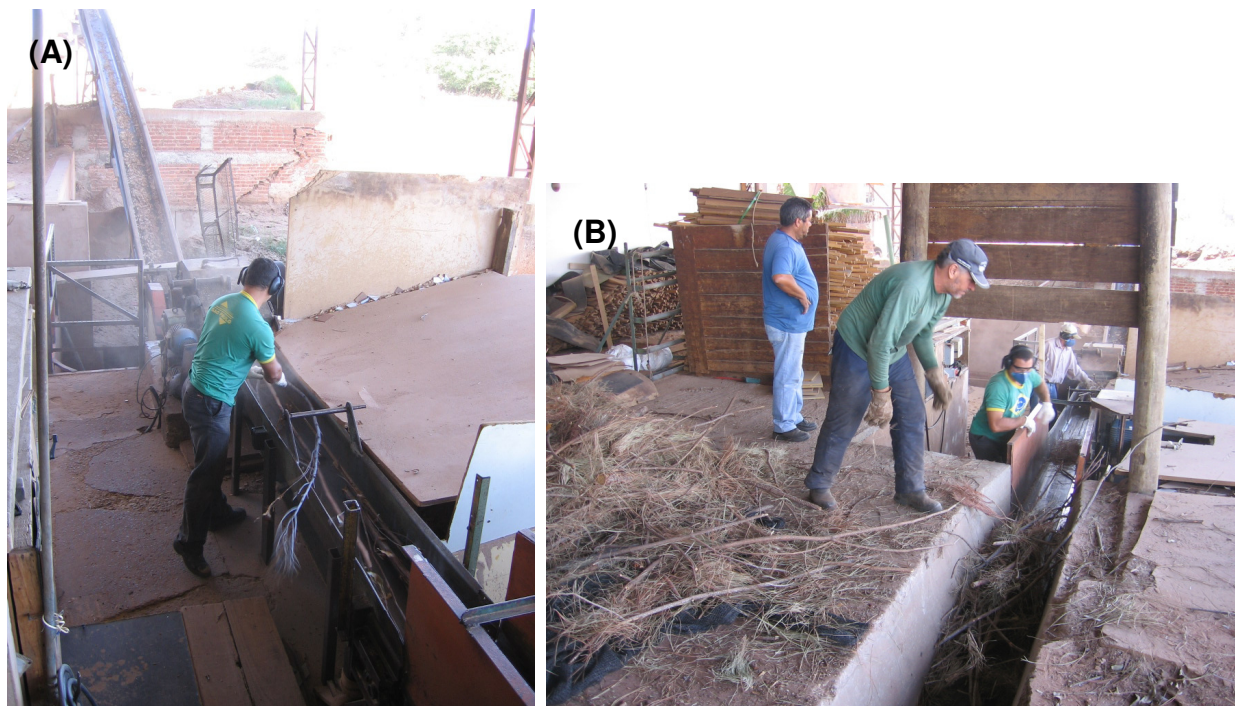
Figura 5 - Picagem de resíduos de (A) eucalipto e (B) pinus por meio de picador a tambor
