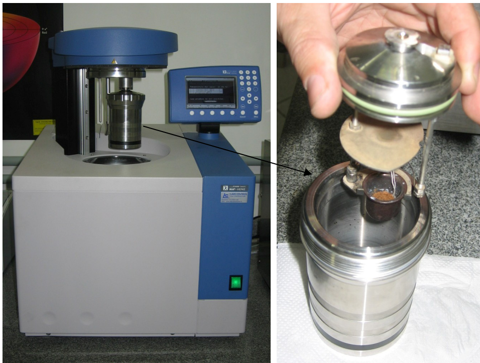
Figura 10 - Determinação do poder calorífico dos resíduos com o equipamento "C 2000 calorimeter system" da Ika®-Werke
