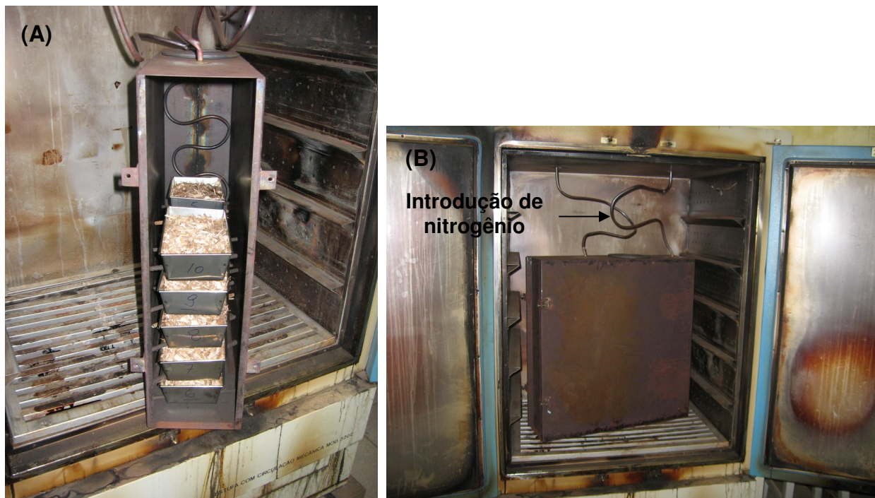
Figura 6 - (A) Bandejas com resíduos de eucalipto colocadas dentro da câmara metálica e (B) câmara fechada introduzida na estufa de tratamento térmico
