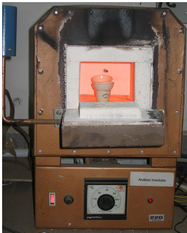
Figura 11 - Ensaio de análise imediata de uma amostra de resíduos utilizando cadinho de platina com tampa e mufla, com capacidade para atingir 1000 °C
