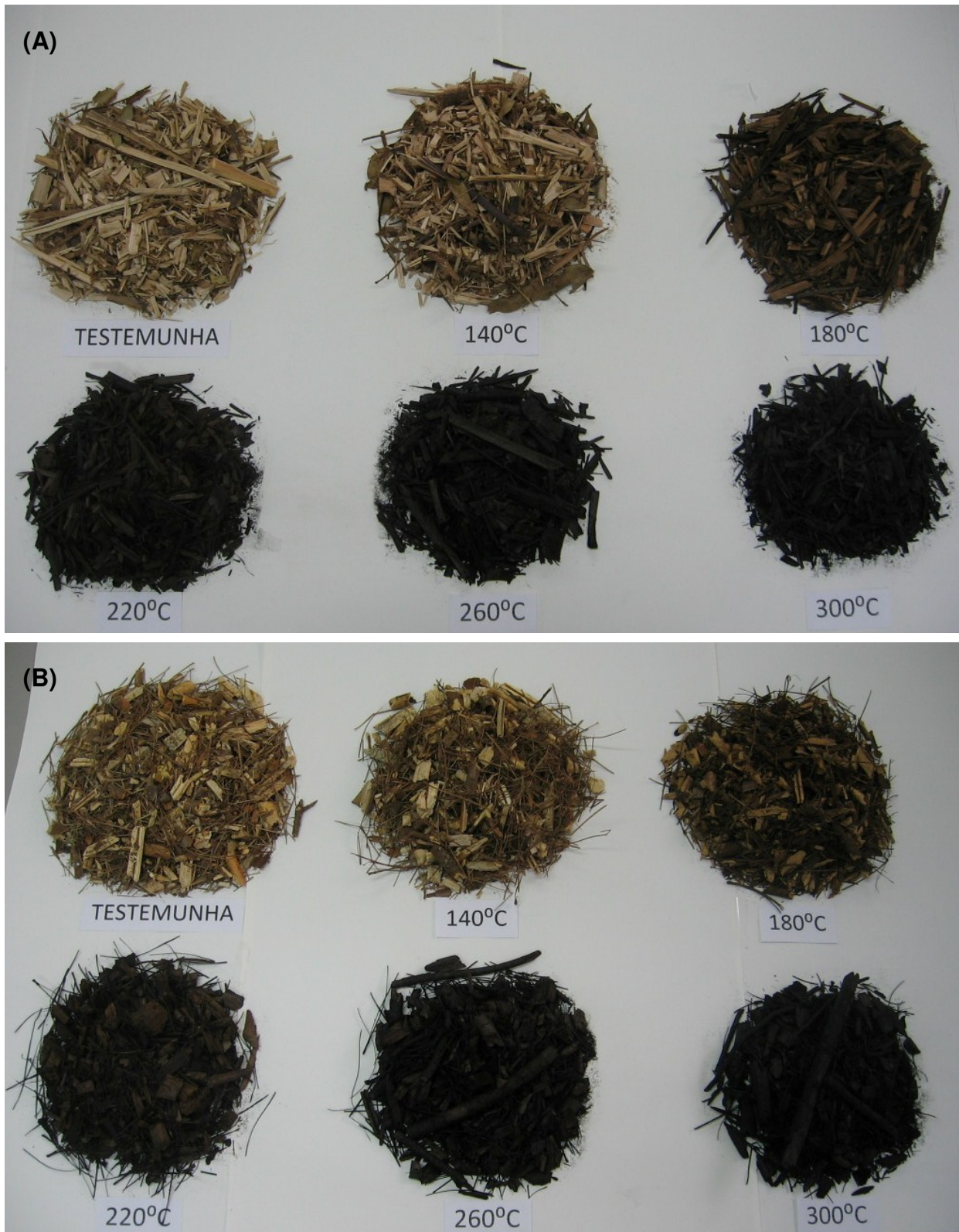
Figura 8 - Resíduos de (A) eucalipto e de (B) pinus tratados termicamente
