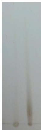
Figura 16 - Placa de celulose de cromatografia de camada delgada (CCD) ilustrando a amostra de resíduo antes da hidrólise (à esquerda) e após a hidrólise ácida (à direita)
