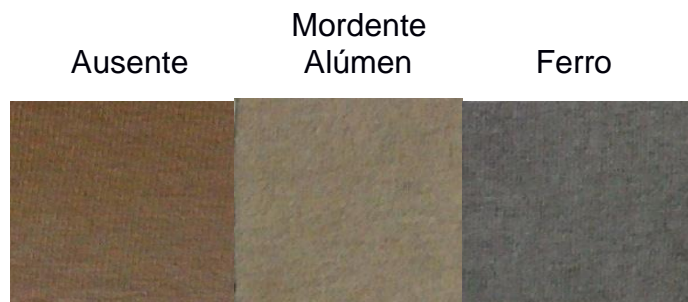
Figura 35 - Efeito da adição de mordentes, sulfato de alumínio e potássio (alúmen) e sulfato de ferro, na cor dos tecidos tingidos com o resíduo
