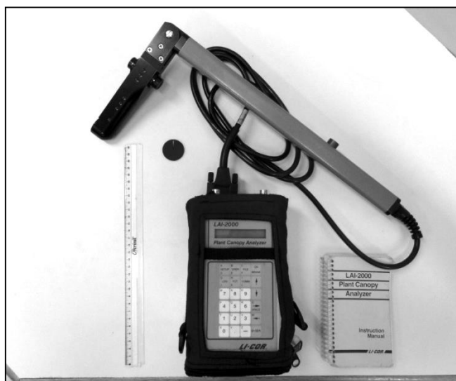
Figura 3.1 – LAI 2000 Plant Canopy Analyser ; ao lado, uma régua de 30 cm e o manual do usuário. Fonte: o autor
