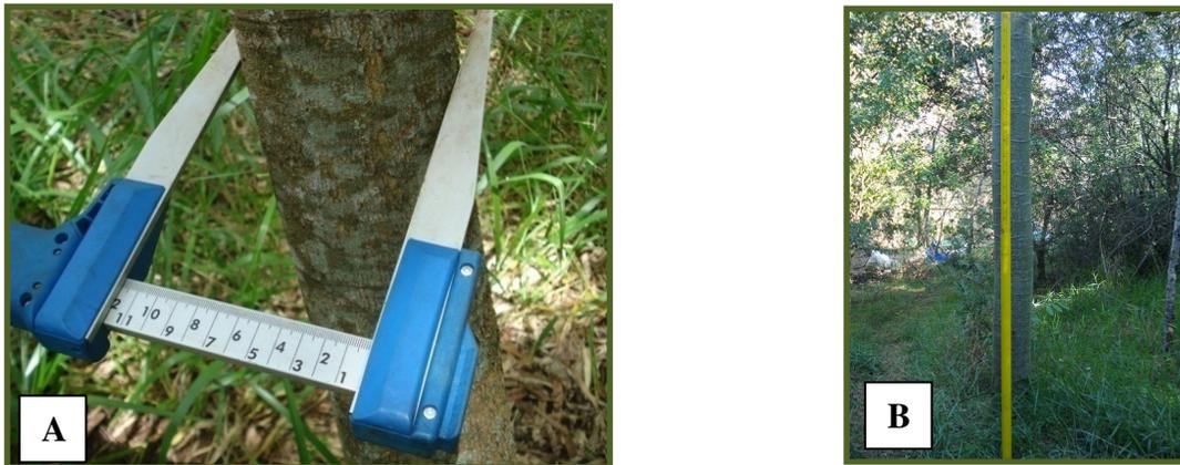
Figura 5 – (A) Suta com precisão de 1 mm usada na medição do diâmetro a altura do peito. (B) Vara telescópica de 15 m com precisão de 1 cm usada na medição da altura total
