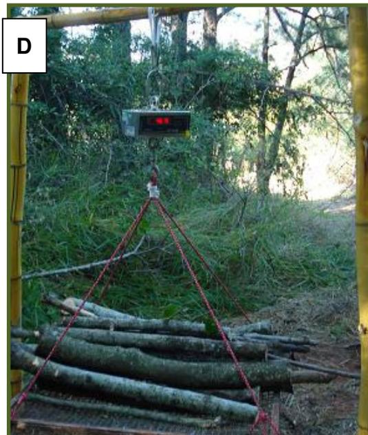
Figura 7 – (A) Árvore derrubada e tronco seccionado; (B) Raízes escavadas superficialmente; (C) Retroescavadeira retirando raízes de uma árvore de grande porte; (D) Dinamômetro digital para pesagem da biomassa úmida em campo
