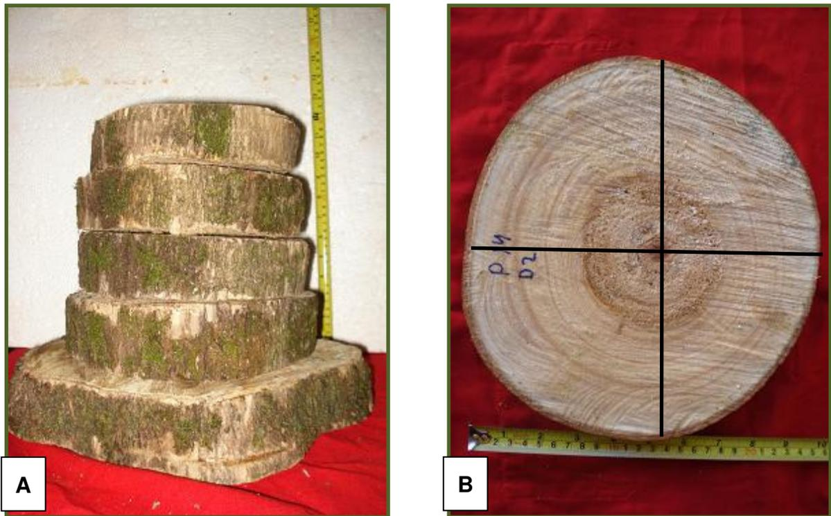
Figura 8 – (A) Cinco discos de 3 a 5 cm de espessura; (B) Cunhas para determinar a densidade básica da madeira
