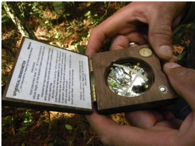
Figura 12 - Densiômetro com adaptação conforme Strickler (1959)
