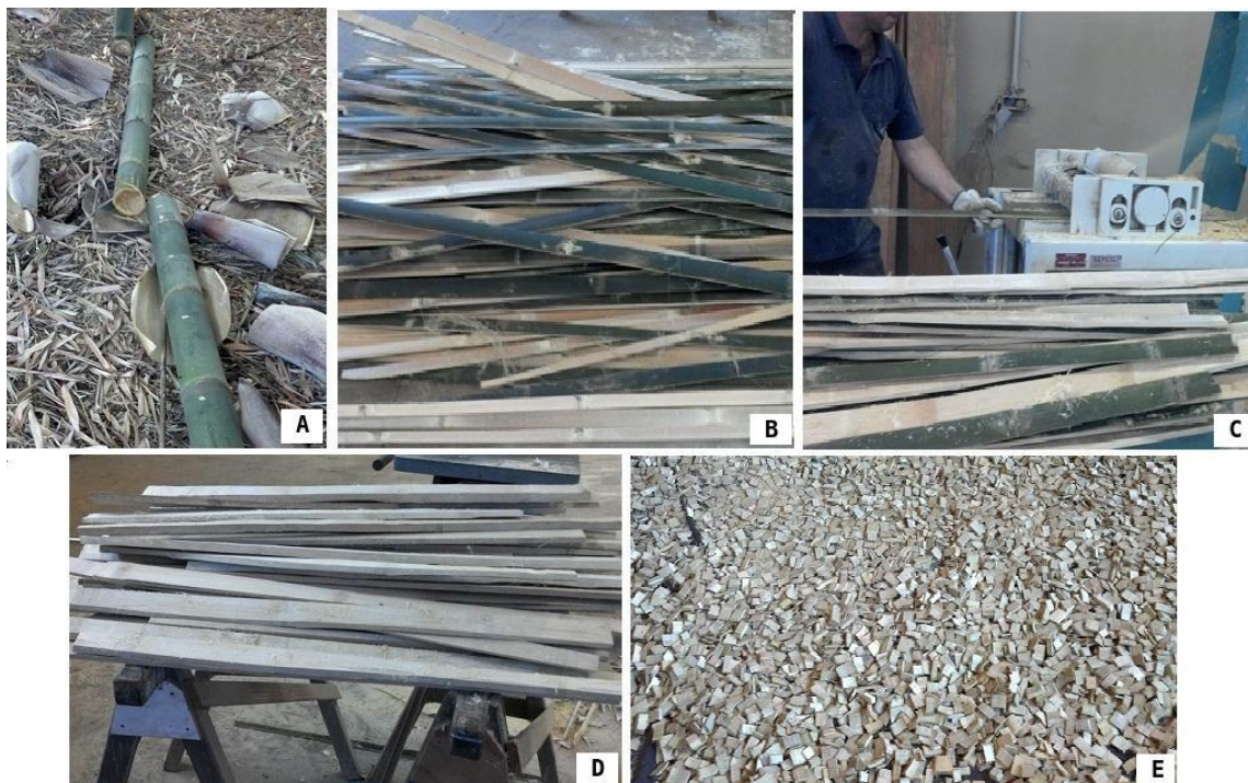
Figura 7. Processamento mecânico do bambu: (A) Colmos seccionados em campo; (B) Taliscas processadas com casca; (C) Desengrosso das Taliscas; (D) Taliscas; (E) Cavacos. Fonte: BRITO, 2018.
