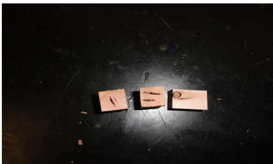
Figura 8: Corpos de prova com colapso e nó.
