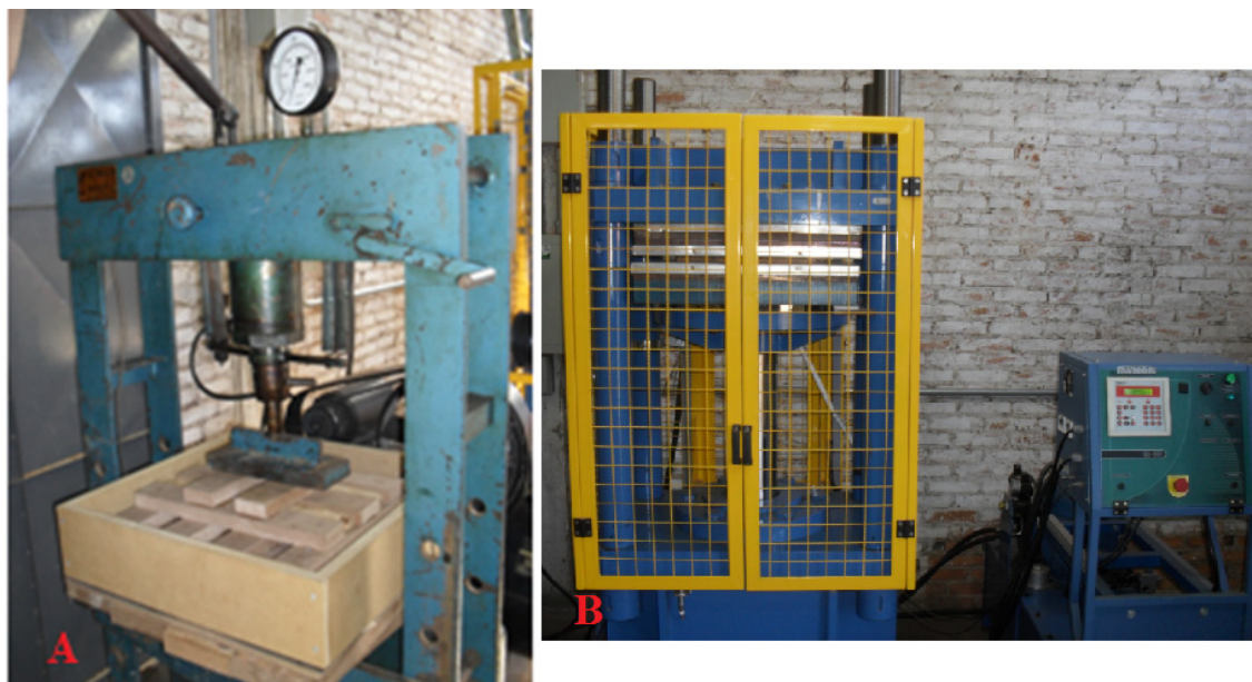
Figura 12 – A) Prensa hidráulica manual, utilizada na pré-prensagem a frio dos colchões de partículas B) Prensa hidráulica motorizada, utilizada na prensagem a quente dos colchões de partículas
